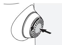
Pritisnite dugme i rotirajte ga u smeru suprotnom od kretanja kazaljki na satu ( $90^\circ$ ).
