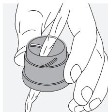
**Čistenie ochranného krytu.** Použite súpravu čistiaceho prostriedku a kefky (dodáva sa so zariadením). Zavorte kryty okulára aj objektívu. Navlhčite kefkou a kruhovými pohybmi naneste čistiaci prostriedok. Jemne kryt vyčistite. Opláchnite ďalekohľad čistou vodou a opatrne ho nechajte vyschnúť. Ak dôjde k namočeniu optiky, jemnými dotykmi čistou handričkou ju vysušte, aby ste predišli jej poškriabaniu. Kefku dôkladne opláchnite a nechajte súpravu čistiaceho prostriedku a kefky vyschnúť.
