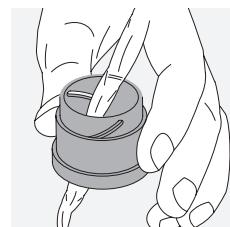
**Curățarea carcasei de protecție.** Utilizați kitul format din săpun și perie (inclus). Acoperiți ocularul și obiectivul cu capacele de protecție. Înmuiati peria și aplicați săpunul, folosind mișcări circulare, pentru a curăța cu atenție carcasa. Clătiți binocul cu apă curată și uscați cu grija. În cazul în care elementele optice se udă, uscați-le cu ajutorul unei pânze curate pentru a împiedica orice zgâriere. Clătiți bine peria și puneți la uscat kitul format din săpun și perie.
