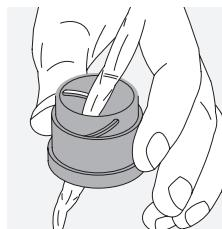
**Čišćenje zaštitnog kućišta.** Koristite komplet sapuna i četke [isporučeno uz proizvod]. Zatvorite poklopac na sočivima okulara i objektiva. Navlažite četku i nanesite sapun primenom kružnih pokreta da biste pažljivo očistili kućište. Isperite dvogled čistom vodom i pažljivo ga osušite. Ako se optičke komponente navlaže, pažljivo ih osušite suvom krpom da biste sprečili grebanje. Temeljno isperite četku i ostavite komplet četke i sapuna da se osuši.
