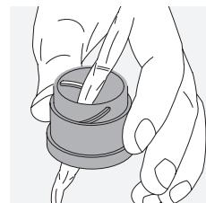
**Čiščenje zaščitnega ohišja.** Uporabite milo in krtačko (priložena). Zaprite pokrov okularja in leče objektiva. Navlažite krtačko in na napravo s krožnimi gibi nanesite milo, da tako rahlo očistite ohišje. Daljnogled izperite s čisto vodo in ga skrbno osušite. Če se optika zmoči, jo popivnjajte s čisto krpou, da je ne opraskate. Temeljito izperite krtačko in pustite, da se milo in krtačka posušita.
