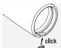
3. Umístěte zátku do kovového kroužku. Až uslyšíte cvaknutí, znamená to, že je kryt připevněn.
