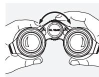
Otočením zaostrovacieho kolieska môžete zaostríť na ľuboľný objekt od najkratšej zaostrovacej vzdialnosti (pozrite list s technickými údajmi) až do nekonečna.
