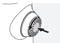
Pritisnite na gumb in ga zasučite v nasprotni smeri urinega kazalca ( $90^\circ$ ).
