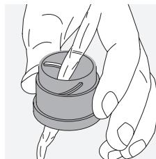
**Čišćenje zaštitnog kućišta.** Upotrijebite komplet sapuna i četke (isporučen). Zatvorite poklopce okulara i leća objektiva. Navlažite četku i kružnim pokretima nanesite sapun kako biste nježno očistili kućište. Isperite dalekozor čistom vodom i pažljivo ga osušite. Ako se optika smoči, osušite je čistom tkaninom kako biste spriječili nastanak ogrebotina. Temeljito isperite četku i pričekajte da se osuši komplet sapuna i četke.
