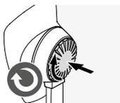
Gumb močno pritisnite navznoter in ga rahlo zasučite v smeri urinega kazalca. Sprostite zatič in gumb še naprej obračajte v smeri urinega kazalca, da se zaskoči.
