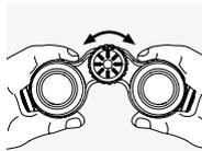
Okretanje kotačića za fokusiranje omogućuje vam da se fokusirate na bilo koji predmet od najmanje udaljenosti fokusiranja (pogledajte tehničke specifikacije) do beskonačnosti.
