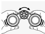
Otočením zaostrovacieho kolieska môžete zaostriť na ľubovoľný objekt od najkratšej zaostrovacej vzdialenosti (pozrite list s technickými údajmi) až do nekonečna.
