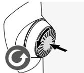
Pritisnite na gumb in ga zasučite v nasprotni smeri urinega kazalca (90 °).
