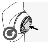
Pritisnite okruglu ručicu i okrenite je u smjeru suprotnom od kazaljke na satu (90°).
