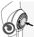
Apăsați ferm pe buton și rotiți ușor în sensul acelor de ceasornic. Oprii acțiunea de apăsare pe ac și continuați să-l rotiți în sensul acelor de ceasornic până când auziți un clic.
