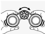
Okretanje točkića za fokusiranje vam omogućava da fokusirate svaki predmet od najkraće udaljenosti fokusiranja (pogleda te dokument s tehničkim specifikacijama) to beskonačnog.
