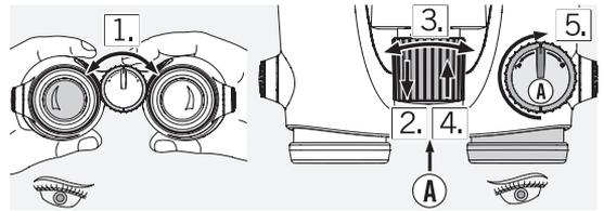
1. Blicken Sie mit dem linken Auge durch das linke Okular und stellen Sie mit dem Fokussierrad die Bildschärfe eines ausgewählten Objektes ein.
