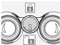
Кольцо фиксации диоптрий фиксируется поворотом на 180° по часовой стрелке. Если его повернуть на 180° против часовой стрелки, оно снова освободится.
