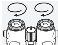
Pos. B: Position de départ avec lunettes : tournez les deux bonnettes oculaires rotatives dans le sens des aiguilles d'une montre jusqu'à la butée.
