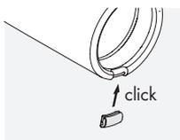
3. Spingere il cappuccio sull'anello di metallo. Il cappuccio non è applicato saldamente fino a che non si sente un clic.
