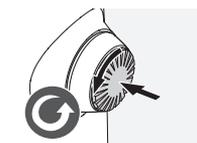
Pressez le bouton vers l'intérieur et tournez-le dans le sens inverse des aiguilles d'une montre (90°).
