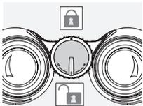
Vous pouvez bloquer le verrouillage de correction dioptrique en le tournant de 180° dans le sens des aiguilles d'une montre. En le tournant de 180° dans le sens inverse des aiguilles d'une montre, vous le débloquentez à nouveau.
