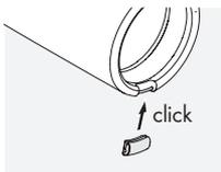
3. Empujar la tapa hacia el anillo metálico. La tapa no está bien colocada hasta que se escucha un clic.
