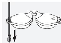
Um einen Okularschutzdeckel oder anderes Zubehör zu montieren, ziehen Sie den Riemen zuerst durch die Öse des jeweiligen Deckels.
