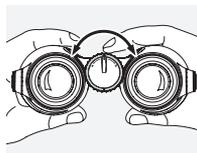
Для настройки резкости изображения объекта с кратчайшего расстояния фокусировки (см. Technical Data Sheet) до бесконечности, просто поверните фокусирующее колесо.
