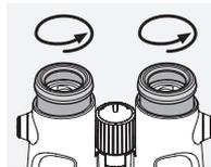
Pos. A: Posizione iniziale senza occhiali: estrarre completamente le conchiglie oculari ruotandole in senso antiorario.
