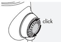
Rilasciare la pressione sul perno e continuare a ruotarlo in senso orario fino a che non scatta in posizione.
