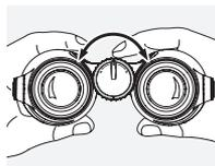
Ved at dreje på fokushjulet kan der indstilles skarpt på hvert objekt fra den korteste afstand (se teknisk datablad) til uendeligt.
