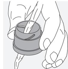
**Suojakotelon puhdistus.** Käytä toimitukseen kuuluvaa saippua- ja harjasarjaa. Sulje okulaari- ja objektiivisuojat. Kostuta harja ja puhdista kotelo varovasti levittämällä saippuaa pyörivin liikkein. Huuhtelee kiikarit puhtaalla vedellä ja kuivaa huolellisesti. Jos optiikka kastuu, painele kuivaksi puhtaalla liinalla, jotta optiikka ei naarmuunnu. Huuhtelee harja perusteellisesti ja jätä saippua- ja harjasarja kuivumaan.
