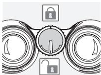
Per bloccare il fermo per la compensazione diottrica basta ruotarlo in senso orario di 180°. Per sbloccarlo, ruotarlo nuovamente di 180° in senso antiorario.
