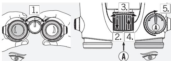
1. Titta genom det vänstra okularet med det vänstra ögat och vrid fokuseringshjulet så att föremålet du tittar på är skarpt.
