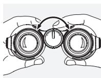
Genom att vrida fokuseringshjulet kan du ställa in skärpan på föremål på mycket nära håll (se tekniska data) och upp till oändligt.
