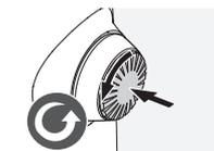
Вдавить кнопку внутрь и повернуть ее против часовой стрелки (90°).
