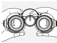
En faisant tourner la molette de focalisation, vous pouvez faire la mise au point sur chaque objet, de la distance minimum de mise au point à l'infini (voir la fiche signalétique technique).
