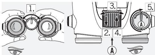
1. Regardez avec l'œil gauche à travers l'oculaire gauche et réglez la netteté d'un objet déterminé à l'aide de la molette de focalisation.
