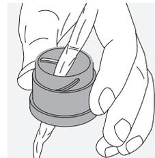
**De behuizing reinigen.** Gebruik hiervoor de meegeleverde zeep en borstelset. Plaats de beschermkappen op de oculairen en objectieven. Maak het borsteltje nat en breng de zeep met ronddraaiende bewegingen aan om de behuizing zachtjes te reinigen. Spoel de verrekijker af met schoon water en droog voorzichtig af. Als het optische systeem nat wordt, dep het dan droog met een schone doek om krassen te voorkomen. Spoel het borsteltje grondig schoon en laat de zeep en borstelset drogen.
