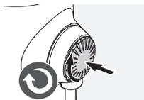
Premere il perno energicamente e ruotarlo leggermente in senso orario.
