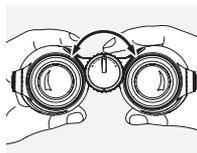
Ruotando la rotella di focalizzazione sarà possibile ottenere un'immagine nitida di qualsiasi oggetto posto ad una distanza ridotta (vedi il manuale con dati tecnici) fino all'infinito.
