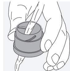
**Очистка корпуса.** Используйте набор из мыла и щетки (входит в комплект поставки). Закройте крышками окуляры и объективы. Смочите щетку, намылите ее и протрите корпус круговыми движениями для бережной очистки. Промойте бинокль чистой водой и тщательно высушите. Если оптика стала влажной, протрите ее насухо чистой тканью, чтобы не поцарапать. Хорошо промойте щетку и высушите набор из мыла и щетки.
