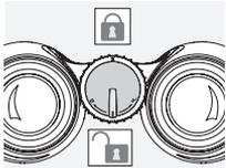
Mit einer 180° Drehung im Uhrzeigersinn wird die Dioptriensperre fixiert. Eine 180° Drehung gegen den Uhrzeigersinn löst diese wieder.
