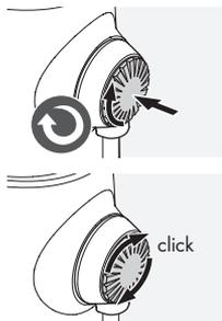
Pressez fermement la goupille et tournez-la un peu dans le sens des aiguilles d'une montre.
