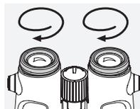
**Pos. B:** Ausgangsposition mit Brille: Drehen Sie beide Drehaugenmuscheln im Uhrzeigersinn bis zum Anschlag hinein.
