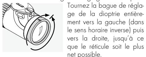
Tournez la bague de réglage de la dioptrie entièrement vers la gauche (dans le sens horaire inverse) puis vers la droite, jusqu'à ce que le réticule soit le plus net possible.
