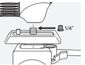
ATC/STC 采用 3/8"UNC 连接螺纹。插入的衬套可将螺纹缩小到 1/4"UNC。因此，螺纹可用于安装连接器快装板，并且单筒望远镜可以兼容全部常见的三脚架云台。
