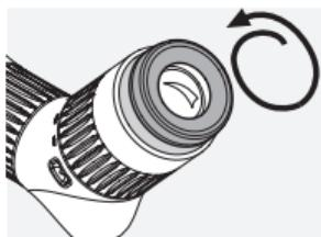
Для использования без очков: выкрутите опускающийся наглазник (против часовой стрелки) до упора.
