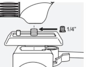
ATC/STC имеет соединительную резьбу  $\frac{3}{8}$ " UNC. Вставленная втулка уменьшает резьбу до  $\frac{1}{4}$ " UNC. Таким образом, резьба может использоваться для крепления штативной площадки и зрительная труба совместима со всеми распространенными головами штатива.
