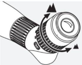
De vergroting wijzigen: draai de zoomring naar rechts voor een grotere vergroting, en naar links voor een kleinere vergroting. De indexmarkering toont de huidige vergrotinstelling.
