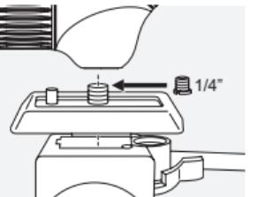
Il telescopio da osservazione ATC/STC è dotato di una filettatura di  $\frac{3}{8}$ " UNC. La boccola inserita riduce la filettatura a  $\frac{1}{4}$ " UNC. La filettatura può quindi essere utilizzata per montare una piastra adattatrice e il telescopio da osservazione è compatibile con tutte le più comuni teste per treppiede.
