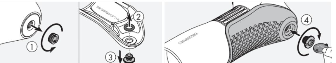
Schritt 3: Befestigen Sie die Halbschale an der Unterseite des Teleskops mit der Klemmschraube.
