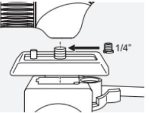
ATC/STC har en  $\frac{3}{8}$  tums UNC-anslutningsgänga. Den bussning som har förts in minskar gängan till en  $\frac{1}{4}$  tums UNC. Gängan kan därför användas för att montera en adapterplatta så att tubkikaren är kompatibel med alla vanliga stativhuvuden.
