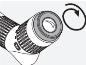
Para utilizarlo con gafas: enrosque la copa ocular giratoria (en el sentido de las agujas del reloj) hasta el tope.
