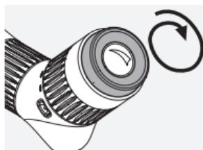
Для использования с очками: закрутите опускающийся наглазник (по часовой стрелке) до упора.
