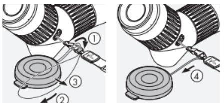
**Примечание:** Если установлен ремень для переноски, крышку окуляра можно закрепить на ремне для переноски.
