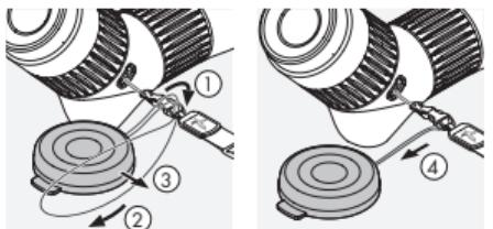
**Hinweis:** Wenn der Trageriemen montiert ist, kann der Okularschutzdeckel am Trageriemen fixiert werden.
