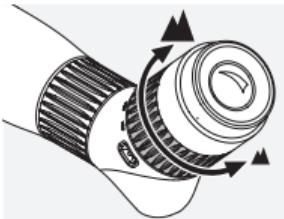
Vergrößerungswechsel: Drehen des Stellrings nach rechts erhöht die Vergrößerung, drehen nach links verringert die Vergrößerung. Die eingestellte Vergrößerung können Sie über den Indexpunkt ablesen.
