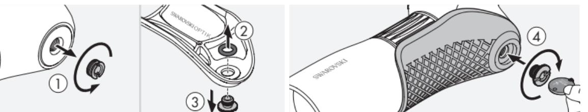
Étape 3 : Installez la demi-coque sur la partie inférieure de la longue-vue d'observation avec la vis de fixation.
