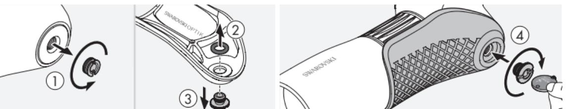
第3步：使用锁紧螺钉将保护壳固定至单筒望远镜底部（硬币或一字螺丝刀）。
