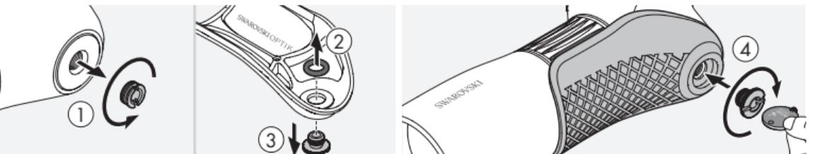
Steg 3: Fäst halvskalet på tubkikarens botten med hjälp av låsskruven.
