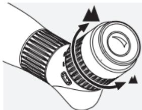
Modificación de aumentos: girar la anilla de ajuste hacia la derecha incrementa los aumentos; girarla hacia la izquierda, los reduce. La marca del índice muestra el ajuste de aumentos actual.
