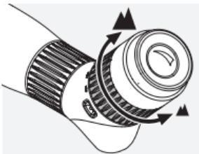
Ändra förstoringen: om du vrider justeringsringen åt höger ökas förstoringen och om du vrider den åt vänster minskas den. Indexmarkeringen visar den aktuella förstoringsinställningen.
