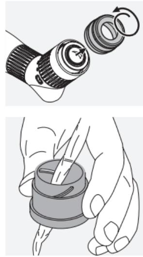
For at sikre, at teleskopets optiske egenskaber opretholdes, skal glasoverfladen holdes fri for snavs, olie og fedt. Optikken rengøres ved først at børste eventuelle større smudspartikler af ved hjælp af en børste til optiklinser. Ånd derefter forsigtigt på linsen, og polér det med rengøringskluden for at fjerne eventuelt resterende snavs.
