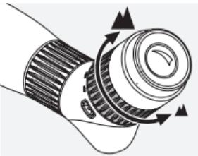
Ændring af forstørrelse: Hvis justeringsringen drejes til højre, øges forstørrelsen, og den formindskes, hvis ringen drejes til venstre. Indeksmaerket viser den aktuelle forstørrelsесindstilling.
