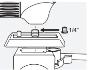
ATC/STC er forsynet med et  $\frac{3}{8}$ " UNC-tilslutningsgevind. Den isatte bøsning reducerer gevindet til  $\frac{1}{4}$ " UNC. Gevindet kan derfor bruges til at montere en adapterplade, og teleskopet er kompatibelt med alle gængse stativhoveder.
