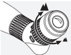
Suurennuksen muuttaminen: Säätörenkaan kääntäminen oikealle lisää suurennusta ja käännettäminen vasemmalle pienentää suurennusta. Merkintä näyttää nykyisen suurennusasetuksen.
