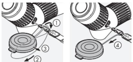
**Opmerking:** Als de draagriem gemonteerd is, kan de oculairkap op de draagriem bevestigd worden.
