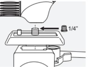
ATC:ssä/STC:ssä on  $\frac{3}{8}$ " UNC-liitintäkierre. Asetettu holki laskee UNC-kierteeksi  $\frac{1}{4}$ ". Kierteen avulla voidaan asentaa sovitinlevy, ja kaukoputki on yhteensopiva kaikkien yleisten kolmijalan päiden kanssa.
