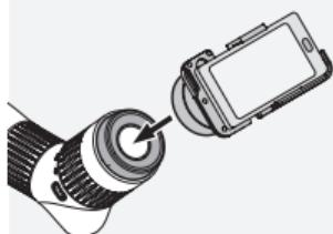
使用施华洛世奇光学公司的望远摄影连接器将您的单筒望远镜变成一个长焦镜头。
