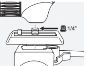
De ATC/STC heeft een  $\frac{3}{8}$ " UNC aansluitschroefdraad. De verloopnippel die is gebruikt, verkleint de draad tot  $\frac{1}{4}$ " UNC. De draad kan daarom worden gebruikt om een snelkoppelplaat te bevestigen en de telescoop is geschikt voor gebruik met alle gangbare statiefkoppen.
