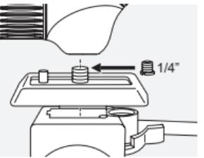
Das ATC/STC verfügt über ein Anschlussgewinde von  $\frac{3}{8}$ " UNC. Die eingesetzte Überschraube reduziert das Anschlussgewinde auf  $\frac{1}{4}$ " UNC. Über das Gewinde kann somit eine Adapterplatte montiert werden und das Teleskop passt in jeden gängigen Stativkopf.
