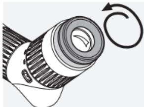
Pour une utilisation sans lunettes : dévissez autant que possible la bonnette oculaire rotative (en la tournant dans le sens inverse des aiguilles d'une montre).
