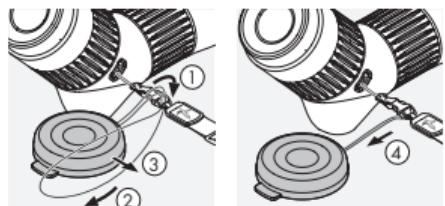
备注：单肩颈带连接再ATC/STC上时，可将目镜防护罩系在单肩颈带上。
