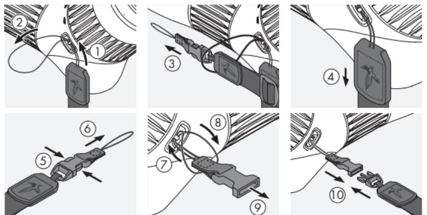
En el otro extremo, libere el mecanismo de clip (5 + 6) y pase el lazo a través del enganche (7). Luego, pase el extremo a través del lazo (8), apriete el bucle (9) y fije el clip al otro extremo de la correa de transporte lateral (10).
