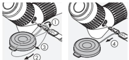
**Nota:** Cuando la correa de transporte está colocada, la tapa del ocular puede fijarse a la correa de transporte.
