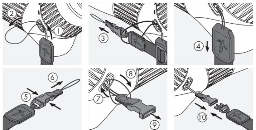
På den anden side løsgøres enden af låsemekanismen (5+6), og løkken føres gennem lokkeholderen (7). Træk derefter enden gennem løkken (8), spænd den (9), og fastgør derefter klipsen i den anden ende af sidebæreremmen (10).
