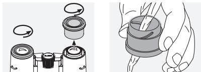
Bei starker Verschmutzung (z.B. Sand) sind die Drehaugenmuscheln komplett abschraubar und somit sehr einfach zu reinigen.
