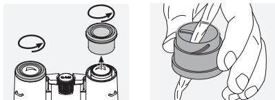
Bij sterke verontreiniging (bijv. zand) kan de oogklep er compleet afgeschroefd worden zodat het oculair eenvoudig kan worden schoongemaakt.
