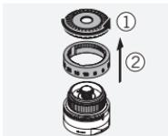
Skruva loss den räflade ringen från tornet. Ta bort den räflade ringen och skalringen (eller markeringsringarna).
