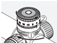
Vérifiez que la tourelle est bien réglée sur zéro, puis bloquez le mécanisme de blocage. Dévissez la bague moletée et retirez-la de la tourelle.
