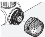
Verwijder het schroefdeksel van de toren aan de zijkant van de richtkijker.
