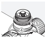
Open het vergrendelingsmechanisme van de toren. Draai de markering op de toren naar nul als deze in een andere positie is gedraaid.
