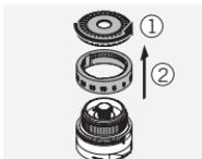
Dévissez la bague moletée et retirez-la de la tourelle. Retirez la bague moletée et la bague graduée (ou les bagues de repérage).
