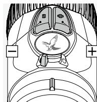
Затем с использованием кнопок +/- можно настроить яркость для выбранного режима. Для быстрого получения идеального уровня яркости можно нажать и удерживать одну из кнопок (длинный импульс).
