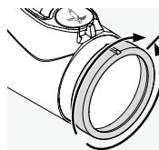
Najprije prsten za namještanje dioptrije zakrenite do kraja uljevo (u smjeru obrnutom od kretanja kazaljki na satu), a zatim ga zakrećite udesno dok se končanica ne izoštiri. Raspon prilagodbe ovisi o modelu. Dodatne informacije pronaći ćete u priloženim tehničkim specifikacijama.
