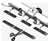
Capacul inclus poate fi folosit pentru a proteja zonele expuse ale șinei. Îl puteți întări la dimensiunile necesare și să-l trageți pe șină folosind degetele dumneavoastră.
