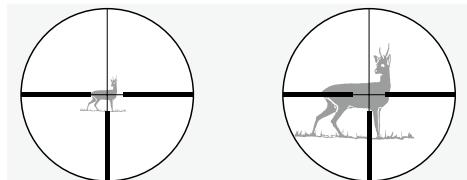
rozmiar siatki celowniczej nie ulega zmianie. Zmienia się natomiast wielkość obrazu. Nawet przy dużych powiększeniach cel jest tylko nieznacznie przesłonięty przez siatkę celowniczą. Siatka celownicza w ograniczonym stopniu nadaje się do szacowania odległości.
