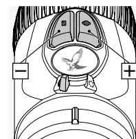
Sad pomoću tipke +/- možete namjestiti svjetlinu za odabrani način rada. Da biste brzo postigli idealnu razinu svjetline, pritisnite i držite jednu od tih tipki (dugačak impuls). Da biste precizno namjestili svjetlinu, jedanput pritisnite jednu od tipki (jednokratan impuls).
