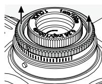
1. Dvignite zunanjji rebričast obroč in ga med obračanjem pridržite v tem položaju. Če ga izpustite, ne bo ostal v dvignjenem položaju.
