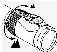
Aby uzyskać wymagane powiększenie, należy obracać pierścień do regulacji powiększenia w zakresie od 0 do 180°. Regulacja powiększenia jest płynna (bezstopniowa). Skala na pierścieniu do regulacji umożliwia łatwy odczyt wybranego ustawienia. Na miękkiej karbowanej osłonie pierścienia do regulacji powiększenia znajduje się wypuska ułatwiająca orientację.
