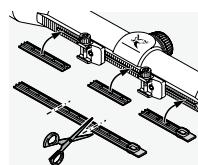
Pomocí dodávaného krytu lze chránit odhalené části lišty. Kryt můžete seříznout na požadovanou velikost a zatlačit jej na lištu prsty.
