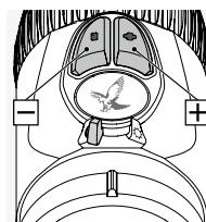
V načinu, ki ste ga izbrali, lahko svetlost nastavite s tipkama +/- . Optimalno svetlost najhitreje najdete tako, da tipko držite pritisnjeno (dolg impulz). Za fino nastavitev pritisnite katero koli od obeh tipk (en impulz).
