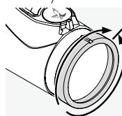
Először csavarja a dioptriaszabályozó gyűrűt teljesen balra (az óramutató járásával ellentétes irányba), majd csavarja jobbra addig, amíg az irányék el nem éri a tökéletes élességet. A beállítás terjedelme az egyes modellektől függően eltérő. További információkat a mellékelt műszaki adatlapon talál.
