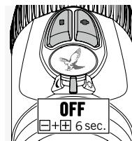
Puteți dezactiva funcția SWAROLIGHT rotind comutatorul OPRIT/ZI/NOAPTE în poziția de mijloc și apăsând butoanele +/- în același timp pentru 6 secunde. Lumina va clipi de două ori pentru a confirma că funcția a fost dezactivată. Puteți reactiva SWAROLIGHT repetând acest pas.
