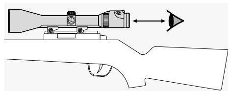
Pravilno podesite maksimalnu razdaljinu na koju možete da postavite oko od okulara za optički nišan koji se montira na oružje (mere potražite u dokumentu sa tehničkim specifikacijama).
