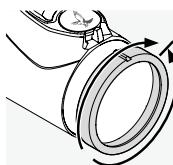
Nejdřív otočte kroužkem vyrovnání dioptrií doleva do krajní pozice (proti směru hodinových ručiček) a potom doleva, dokud nebude záměrná osnova plně zaostřena. Rozsah nastavení se liší podle konkrétního modelu. Další informace najeznete v přiloženém listu s technickými daty.
