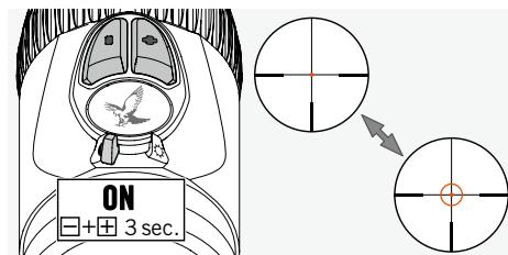
Če želite vklopiti osvetljen obroč merilnega križa FLEXCHANGE 4A-IF, premaknite stikalo IZKLOP/DAN/NOČ v položaj DAN ali NOČ. Osvetlitev merilnega križa je zdaj aktivirana. Če želite vklopiti osvetljen obroč, hkrati pritisnite gumbo +/- za 3 sekunde. Če želite obroč znova izklopliti, ponovite ta postopek.
