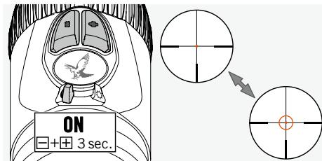
Prepnutím prepínača VYP./DEŇ/NOC do polohy DEŇ alebo NOC zapnete osvetlený krúžok zámernej osnovy FLEXCHANGE 4A-IF. Osvetlenie zámernej osnovy je aktivované. Súčasným stlačením a podržaním tlačidiel +/- na 3 sekundy zapnete osvetlený krúžok. Krúžok znova vypnite opäťovným vykonaním rovnakého postupu.
