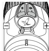
A kiválasztott módban a fényerő a + és a - gomb segítségével állíthatja be. Az ideális fényerő gyors beállításához tartsa lenyomva az egyik gombot [tar-tós impulzus]. A gombok egyszeri megnyomásával (egyszeri impulzus) a finombeállítást végezheti el..
