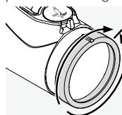
Najpierw należy przekręcić pierścień do regulacji dioptrii do oporu w lewo (w kierunku przeciwnym do ruchu wskazówek zegara), a następnie obracać go w prawo do uzyskania optymalnej ostrości siatki celowniczej. Zakres regulacji zależy od modelu lunety. Więcej informacji można znaleźć w specyfikacji technicznej dołączonej do produktu.
