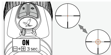
Aby włączyć podświetlony pierścień siatki celowniczej FLEXCHANGE 4A-IF, należy ustawić przełącznik OFF/DZIĘŃ/NOC na tryb DZIĘŃ lub NOC. Uruchomi to podświetlenie siatki celowniczej. Następnie należy jednocześnie wcisnąć przyciski +/- i przytrzymać je przez 3 sekundy, aby włączyć podświetlony pierścień. Aby go wyłączyć, należy powtórzyć powyższe czynności.
