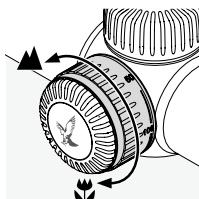
Pomocí věžičky paralaxy můžete upravit zaostření pro jakoukoli vzdálenost k cíli a zabránit chybám mření způsobeným paralaxou.
