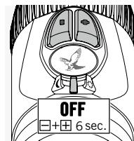
Funkci SWAROLIGHT můžete deaktivovat přepnutím přepínače VYP/DEN/NOC do střední polohy a současným stisknutím a podržením tlačítek +/- po dobu 6 s. Světlo dvakrát zablíká a potvrdí vypnutí funkce. Opětovným provedením stejného postupu můžete funkci SWAROLIGHT znova aktivovat.
