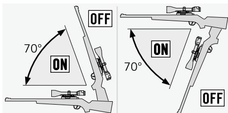
Ciljnik se isključuje i ako je bočni nagib veći od  $30^\circ$  (kad, primjerice, položite pušku na noge).
