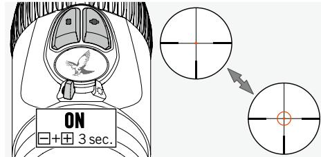
Prebacite prekidač ISKLJUČENO/DAN/NOĆ na položaj DAN ili NOĆ da biste uključili osvetljeni prsten končanice FLEXCHANGE 4A-IF. Sada je aktivirano osvetljenje končanice. Istovremeno držite pritisnutu dugmad +/- 3 sekunde da biste uključili osvetljeni prsten. Ponovite ovaj korak da biste ponovo isključili prsten.
