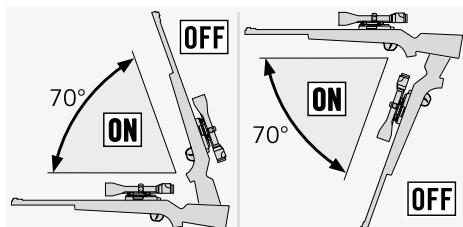
Luneta se oprește și dacă unghiul de înclinare orizontală este mai mare de 30° (dacă, de exemplu, oți aşezat arma pe picioarele dumneavoastră).
