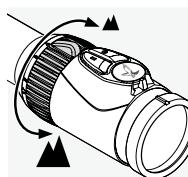
Zakrenite prsten za namještanje uvećanja za do 180° da biste postigli potrebno uvećanje. Uvećanje se mijenja kontinuirano. Brojilo na prstenu za uvećanje olakšava prepoznavanje postavke. Na mekanom nazubljenom pokrovu prstena za uvećanje nalazi se mala izbočina koja olakšava orientaciju.
