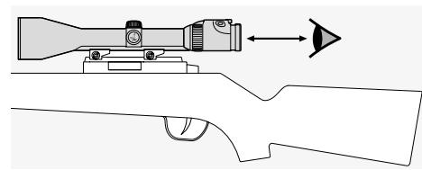
Po zamontowaniu lunety celowniczej na broni należy prawidłowo ustawić odległość źrenicy wyjściowej (informacje dotyczące pomiarów można znaleźć w specyfikacji technicznej).
