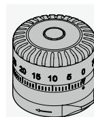
Turela balistică reglabilă (BTF) poate fi configurată separat și vă permite să urmăriți țintă la distanțele necesare. Dacă este folosită pe post de turelă superioară, aceasta poate compensa deviația verticală a glonțului. Când este utilizată pe post de turelă laterală, aceasta este ideală pentru corecții de ochire pe orizontală sau pentru estimarea distanței până la țintă. BTF poate fi montată fără ajutorul unui instrument și poate fi utilizată împreună cu orice tip de reticul.
