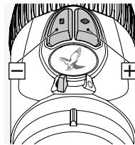
Nyní můžete nastavovat jas ve vybraném režimu pomocí tlačítka +/- . Pokud chcete rychle nastavit ideální úroveň jasu, můžete některé z tlačítka stisknout a podržet (dlouhý impulz). Pokud chcete provádět přesné úpravy nastavení, jednou krátce stiskněte příslušné tlačítko (jeden impulz).
