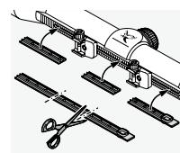
Osłona wchodząca w skład zestawu służy do ochrony odsłoniętych części szyny montażowej. Osłonę można dociąć do odpowiedniego rozmiaru i wcisnąć w szynę palcami.
