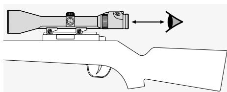
Nastavte správnou vzdálenost výstupní pupily pro puškohled namontovaný na zbrani (příslušná měření naleznete v listu s technickými údaji).
