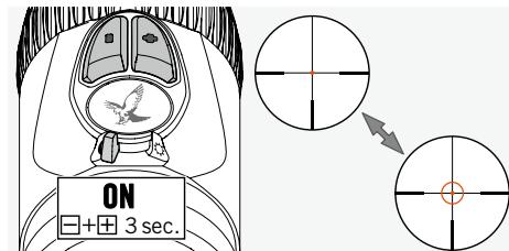
Přepnutím přepínače VYP/DEN/NOC do polohy DEN nebo NOC zapněte osvětlený kroužek záměrné osnovy FLEXCHANGE 4AIF. Osvětlení záměrné osnovy bude aktivováno. Současným stisknutím a podržením tlačítek +/- po dobu 3 s zapněte osvětlený kroužek. Kroužek znova vypněte opětovným provedením stejného postupu.
