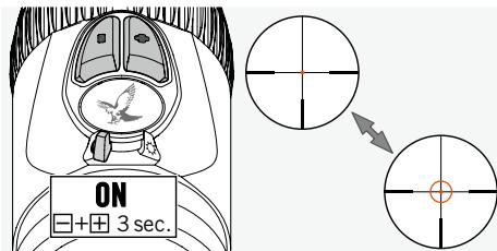
A FLEXCHANGE 4A-IF irányzék világító gyűrűjének bekapsolásához forgassa a KI/NAPPALI/ÉJSZAKAI kapcsolót NAPPALI vagy ÉJSZAKAI állásba. Ezzel bekapsolta az irányzék világítását. A világító gyűrű bekapsolásához 3 másodpercre nyomja le egyszerre a + és a - gombot. A gyűrű kikapcsolásához ismételje meg a fenti műveletet.
