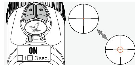
Okrenite prekidač ISKLJUČIVANJE/DAN/NOĆ u položaj DAN ili NOĆ da biste uključili osvjetljeni prsten končanice FLEXCHANGE 4A-IF. Tako ćete aktivirati osvjetljenje končanice. Istodobno pritisnite i 3 sekunde držite tipke +/- da biste uključili osvjetljeni prsten. Da biste prsten isključili, ponovite taj korak.
