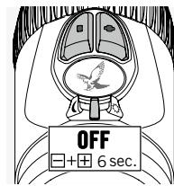
Funkcję SWAROLIGHT można wyłączyć, ustawiając przełącznik OFF/DZIĘŃ/NOC w centralnym położeniu oraz wciskając jednocześnie przyciski +/- i przytrzymując je przez 6 sekund. Wyłączenie tej funkcji zostanie potwierdzone przez dwukrotny błysk światła. Aby ponownie włączyć funkcję SWAROLIGHT, należy powtórzyć powyższe czynności.
