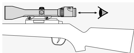
Pravilno postavite očišće za ciljnik koji je montiran na oružje (mjere potražite u tehničkim specifikacijama).
