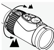
Otáčejte kroužkem nastavení zvětšení v rozsahu 180°, dokud nedosáhnete požadované zvětšení. Nastavení je průběžné. Stupnice na nastavovacím kroužku usnadňuje vyhledání požadovaného nastavení. Jemně vroubkovaná krytka nastavovacího kroužku je vybavena malým výčnělkem, který usnadňuje orientaci.
