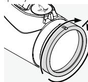
Сначала поверните кольцо диоптрической настройки влево (против часовой стрелки) до упора, а затем поворачивайте вправо, пока прицельная марка не будет в резком фокусе.
