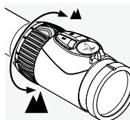
Obroč za prilagoditev povečave lahko zasukate do 180°, da dobite želeno povečavo. Postopek prilagojevanja je kontinuiran. Skala na obroču za prilagajanje omogoča preprost pregled nastavitev. Na mehkem, rebričastem pokrovu obroča za prilagoditev je majhna vdrtina, ki omogoča preprostejo orientacijo.
