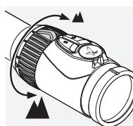
A kívánt nagytást a 180°-os forgatást lehetővé tevő nagytássállító gyűrű elforgatásával állíthatja be. A nagytási arány fokozatmentesen változik. Az állítógyűrűn található skála lehetővé teszi a beállítás egyszerű leolvasását. A könnyebb tájékozódás érdekében a puha, bordázott állítógyűrű-bevonatot kisméretű nyúlvánnyal láttuk el.
