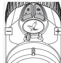
Nyní můžete nastavovat jas ve vybraném režimu pomocí tlačítek +/- . Pokud chcete rychle nastavit ideální úroveň jasu, můžete některé z tlačítek stisknout a podržet (dlouhý impulz). Pokud chcete provádět přesné úpravy nastavení, jednou krátce stiskněte příslušné tlačítko (jeden impulz).
