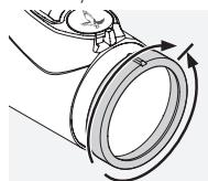
Először csavarja a dioptriaszabályozó gyűrűt teljesen balra (az óramutató járásával ellentétes irányba), majd csavarja jobbra addig, amíg az irányék el nem éri a tökéletes élességet. A beállítás terjedelme az egyes modellektől függően eltérő. További információkat a mellékelt műszaki adatlapon talál.
