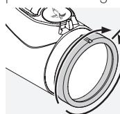
Najpierw należy przekręcić pierścień do regulacji dioptrii do oporu w lewo (w kierunku przeciwnym do ruchu wskazówek zegara), a następnie obracać go w prawo do uzyskania optymalnej ostrości siatki celowniczej.
