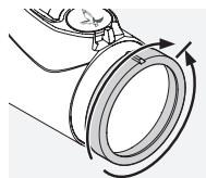
Najprije prsten za namještanje dioptrije zakrenite do kraja uljevo (u smjeru obrnutom od kretanja kazaljki na satu), a zatim ga zakrećite udesno dok se končanica ne izoštiri. Raspon prilagodbe ovisi o modelu. Dodatne informacije pronaći ćete u priloženim tehničkim specifikacijama.
