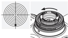
Поверните внешнее рифленое кольцо на верхней турели в направлении H (против часовой стрелки).
