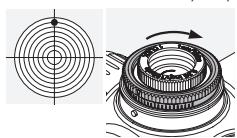
Należy obrócić zewnętrzny pierścień moletowany na pokrętłe górnym w kierunku przeciwnym do litery H (zgodnie z ruchem wskazówek zegara).
