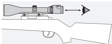
Po zamontowaniu lunety celowniczej na broni należy prawidłowo ustawić odległość źrenicy wyjściowej (informacje dotyczące pomiarów można znaleźć w specyfikacji technicznej).
