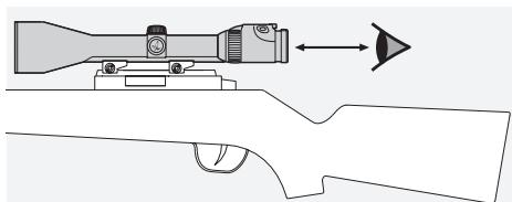
Pravilno podesite maksimalnu razdaljinu na koju možete da postavite oko od okulara za optički nišan koji se montira na oružje (mere potražite u dokumentu sa tehničkim specifikacijama).
