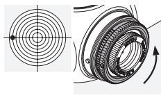
Zakrenite vanjski nazubljeni prsten na bočnoj okretnoj glavi u smjeru oznake R (suprotno od kretanja kazaljke na satu).
