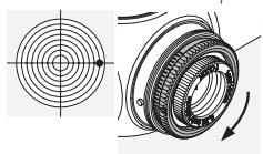
Należy obrócić zewnętrzny pierścień moletowany na pokrętłe bocznym w kierunku przeciwnym do litery R (zgodnie z ruchem wskazówek zegara).
