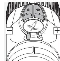
Acum puteți regla luminozitatea în modul selectat folosind butoanele +/- . Pentru a obține rapid nivelul dorit de luminozitate, apăsați și țineți apăsat unul dintre butoane (puls lung). Pentru a face reglație fină, apăsați o singură dată oricare dintre butoane (puls scurt).
