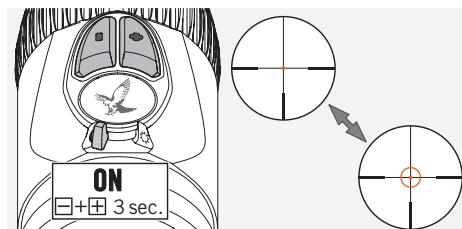
Přepnutím přepínače VYP/DEN/NOC do polohy DEN nebo NOC zapněte osvětlený kroužek záměrné osnovy FLEXCHANGE 4AIF. Osvětlení záměrné osnovy bude aktivováno. Současným stisknutím a podržením tlačítka +/- po dobu 3 s zapněte osvětlený kroužek. Kroužek znova vypněte opětovným provedením stejného postupu.
