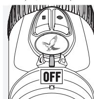
Aby wyłączyć podświetlenie, należy ustawić przełącznik OFF/DZIEN/NOC w centralnym położeniu.
