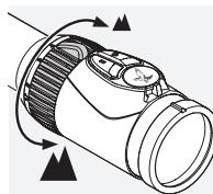
Aby uzyskać wymagane powiększenie, należy obracać pierścień do regulacji powiększenia w zakresie od 0 do 180°. Regulacja powiększenia jest płynna (bezstopniowa). Skala na pierścieniu do regulacji umożliwia łatwy odczyt wybranego ustawienia. Na miękkiej karbowanej osłonie pierścienia do regulacji powiększenia znajduje się wypustka ułatwiająca orientację.
