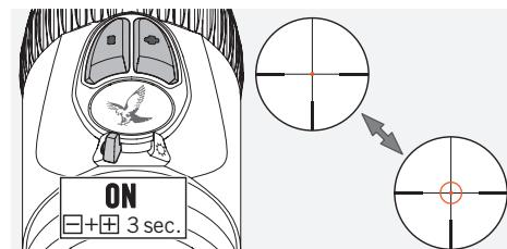
Rotiți comutatorul OPRIT/ZI/NOAPTE în poziția de ZI sau NOAPTE pentru a porni inelul iluminat al reticulului FLEXCHANGE 4A.IF. Iluminarea reticulului este pornită. Apăsați butoanele +/- în același timp pentru 3 secunde pentru a porni inelul iluminat. Repetați acest pas pentru a opri din nou inelul.
