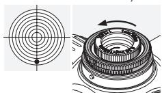
Należy obrócić zewnętrzny pierścień moletowany na pokrętłe górnym w kierunku litery H (przeciwne do ruchu wskazówek zegara).
