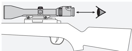
Setați în mod corect distanța de la ochi în cazul lunetei montate pe o armă de foc (consultați fișa tehnică pentru detalii).
