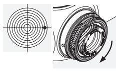
Zakrenite vanjski nazubljeni prsten na bočnoj okretnoj glavi suprotno od smjera oznake R (u smjeru kretanja kazaljke na satu).
