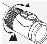
Otáčajte krúžok nastavenia zváčšenia v rozsahu 180°, až kým nedosiahnete požadované zváčšenie. Nastavenie je priebežné. Stupnica na nastavovacom krúžku uľahčuje vyhľadanie požadovaného nastavenia. Jemne vrúbkovaná krytka nastavovacieho krúžku je vybavená malým výčnelkom, ktorý uľahčuje orientáciu.
