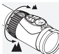
Rotiți inelul de reglare a magnificației până la 180° pentru a obține magnificația necesară. Reglarea este continuă. Scala de pe inelul de reglare face această setare ușor vizibilă. Capacul moale cu nervuri din inelul de reglare are o mică proeminență pentru a ușura orientarea.
