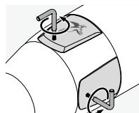
2. Kryty na nastavenie výškovej a stranovej korekcie je možné otvoriť pomocou priloženého skrutkovača Torx (TX 6). Potom môžete nastaviť výškovú a stranovú korekciu pomocou priloženého nastavovacieho nástroja alebo veľkého nastavovacieho nástroja (pozrite bod 1. „Prehľad“, poloha 15).
