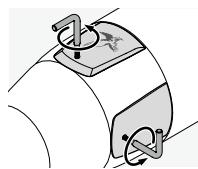
2. Poklopac uskladištanja po vertikali i horizontali može se otvoriti isporučenim križnim odvijačem (TX 6). Zatim možete uskladiti po vertikali i horizontali alatom za namještanje ili velikim alatom za namještanje (pogledajte točku 1. „Pregled“, položaj 15.).
