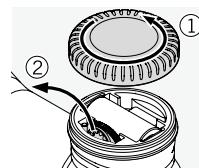
1. Odprite pokrov baterije in odstranite izvijač Torx ter nastavno orodje.
