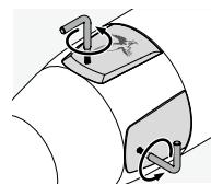
2. Capacele pentru instrumentele dedicate reglării pe înălțime și în lateral pot fi deschise cu cheia torx (TX 6) inclusă. După aceea, puteți regla pe înălțime și în lateral cu instrumentul de reglare sau instrumentul de reglare mare inclus (a se vedea Punctul 1. „Prezentare generală”, poziția 15).
