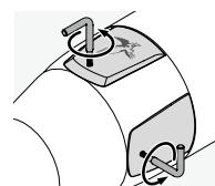
2. Függőleges és oldalirányú beállításhoz a fedeleket a mellékelt Torx kulcs (TX 6) használatával távolíthatja el. Ezután a mellékelt beállítószerszámmal vagy nagy beállítószerszámmal végezheti el a függőleges és oldalirányú beállítást (lásd: 1. pont „Áttekintés”, 15-ös pozíció).
