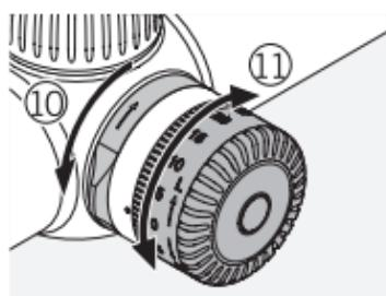
Otvorite mehanizam za zaključavanje okretne glave. Sad možete odabratи željene postavke.
