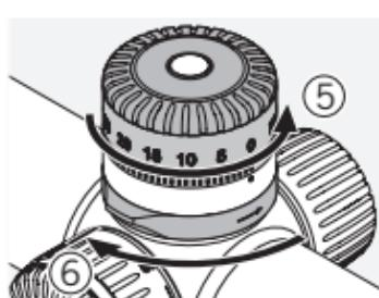
Zdaj lahko izberete želene nastavite na vrtljivi glavi. Zasukajte mehanizem za zaklepanje četrtino obrata v smeri urinega kazalca, da ga zaklenete.
