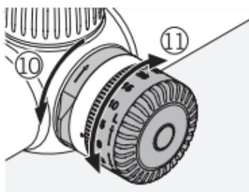
Odprite mehanizem za zaklepanje na vrtljivi glavi. Zdaj lahko izberete želene nastavitev.
