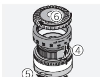
Montirajte desni/lijevi stupnjevani prsten. Provjerite je li nula poravnana s točkom pokazatelja. Zatvorite mehanizam za zaključavanje.
