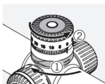
Ellenőrizze a tornyon a nullpontbeállítást, majd zárja a zárszerkezetet. Csavarja le a bordázott gyűrűt a toronyról.
