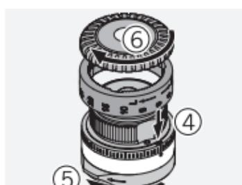
Postavite desni/levi gradirani prsten. Uverite se da je nula poravnata sa indeksnom tačkom. Zatim zatvorite mehanizam za zaključavanje. Ponovo zavijte izrečkani prsten na turet.
