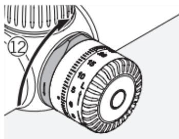
Mehanizam za zaključavanje okrenite za jednu četvrtinu u smeru kretanja kazaljki na satu da biste ga zaključali.
