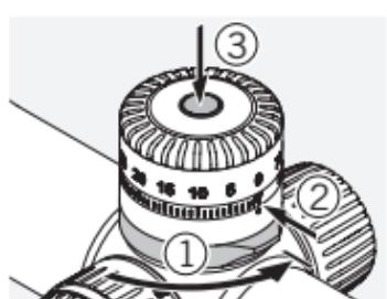
Otevřete uzamykací mechanismus na věžičce. **Zkontrolujte nulovou pozici.** Pomocí špičatého předmětu zatlačte na střední část věžičky.
