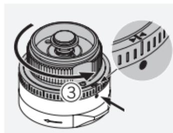
Okrenite turet za 35 klikova u smeru suprotnom od kretanja kazaljki na satu i poravnajte oznaku  $>\backslash<$  na vrhu skale sa indeksnom tačkom. Zatim zatvorite mehanizam za zaključavanje.
