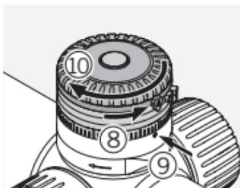
După ce instalați inelele de marcat pe turelă, însurubați la loc inelul cu striații.
