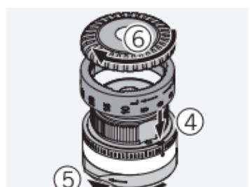
Nainstalujte pravý/levý kroužek se stupnicí. Ujistěte se, že je nula zarovnána s bodem indexu. Zavřete uzamykací mechanismus. Znovu našroubuje vroubkovaný kroužek na věžičku.
