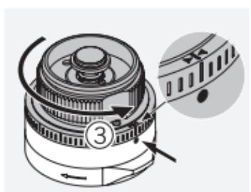
Vrtljivo glavo zasukajte 35 klikov v nasprotni smeri urinega kazalca in poravnajte oznako >|< na vrhu skale z indeksno točko. Nato zaprite mehanizem za zaklepanje.
