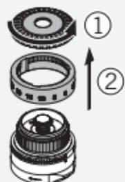
Deșurubați inelul cu striații de pe turelă. Scoateți inelul cu striații și inelul cu scara gradată (sau inelele de marcăre).
