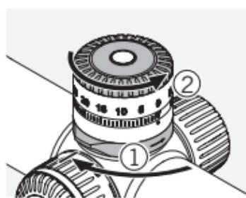
Nastavite vrednost nič na vrtljivi glavi in zaklenite mehanizem za zaklepanje. Odvijte rebričast obroč z vrtljive glave.
