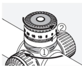
Verificați poziția zero a turelei și blocați mecanismul de blocare. Deșurubați inelul cu striații de pe turelă.
