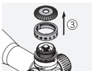
Scoateți inelul cu striații și inelul cu scara gradată.
