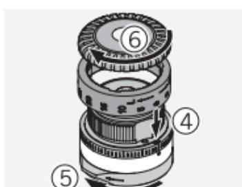
Montați inelul dreapta/stânga cu scara gradată. Asigurați-vă că poziția zero este aliniată cu punctul de referință. Închideți mecanismul de blocare. Reînsurubați inelul cu striații pe turelă.
