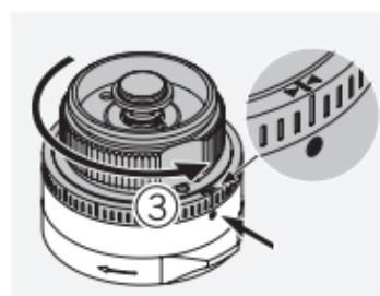
Otočte vežičku o 35 kliknutí proti smeru hodinových ručičiek a zarovnajte značku >|< v hornej časti stupnice s bodom indexu. Potom zatvorte uzamykací mechanizmus.
