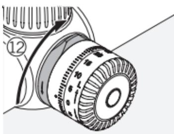
Otočením uzamykacího mechanismu o jednu čtvrtinu otáčky jej uzamkněte.
