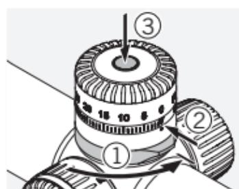
Otvorite mehanizam za zaključavanje na turetu. **Proverite položaj nule.** Šiljatim predmetom pritisnite sredinu tureta.
