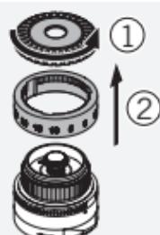
Csavarja le a bordázott gyűrűt a toronról. Távolítsa el a bordázott gyűrűt és a gravírozott gyűrűt (vagy a jelzőgyűrűket).
