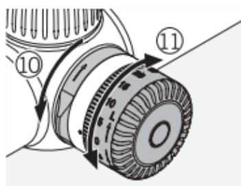
Otvorite mehanizam za zaključavanje tureta. Sad možete da izaberete željene postavke.
