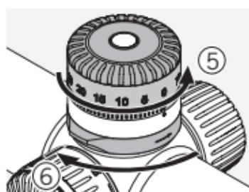
Sad možete odabratи željene postavke na okretnoj glavi. Zakrajenite mehanizam za zaključavanje za četvrtinu okretaja u smjeru kazaljke na satu da biste je zaključali.
