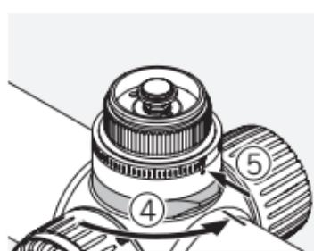
Deschideți mecanismul de blocare al turelei. Setați marcajul turelei pe zero dacă acesta își schimbă poziția.
