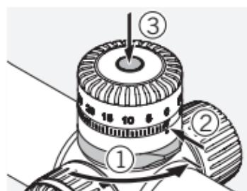
Otvorite mehanizam za zaključavanje okretne glave. **Provjerite je li okretna glava u nultom položaju.** Oštrim predmetom pritisnite sredinu okretne glave.
