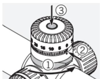
Odprite mehanizem za zaklepanje na vrtljivi glavi. **Bodite pozorni na položaj vrednosti nič.** Uporabite koničast predmet in z njim pritisnite na sredini vrtljive glave.
