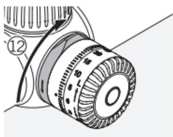
Zakrenite mehanizam za zaključavanje za četvrtinu okretaja u smjeru kazaljke na satu da biste je zaključali.
