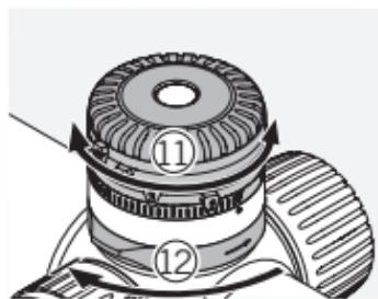
Sad možete da izabirate željene postavke. Mehanizam za zaključavanje okrenite za jednu četvrtinu u smeru kretanja kazaljki na satu da biste ga zaključali.
