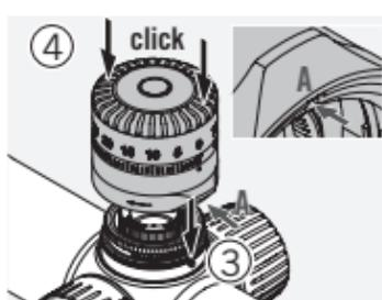
Helyezze a tornyot a céltávcsőre, amíg a helyére nem kattan. Ügyeljen arra, hogy eközben a nullpont-beállítás ne mozduljon el.
