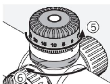
Sad na turetu možete da izaberete željene postavke. Mehanizam za zaključavanje okrenite za jednu četvrtinu u smeru kretanja kazaljki na satu da biste ga zaključali.
