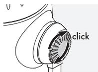
Otpustite pritisak zatika i nastavite ga okretati u smjeru kazaljke na satu dok ne začujete klik.
