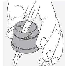
**Čišćenje zaštitnog kućišta.** Upotrijebite komplet sapuna i četkice (isporučeno). Zatvorite poklopce na okulatoru i leće objektivna. Namočite četkicu i nanesite sapun pomoću kružnih pokreta za nježno čišćenje kućišta. Isperite dalekozor čistom vodom i pažljivo ga osušite. Ako se optika smoči, osušite je tapkanjem suhom krpicom da biste izbjegli ogrebotine. Temeljito isperite četkicu i ostavite komplet sapuna i četkice da se osuši.
