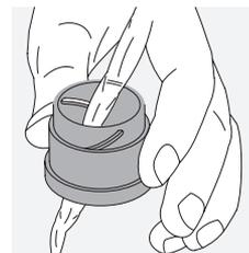
**Curățarea carcasei de protecție.** Utilizați kitul format din săpun și perie (inclus). Acoperiți ocularul și obiectivul cu capacele de protecție. Înmuiați peria și aplicați săpunul, folosind mișcări circulare, pentru a curăța cu atenție carcasa. Clătiți binocul cu apă curată și uscați cu grijă. În cazul în care elementele optice se udă, uscați-le cu ajutorul unei pânze curate pentru a împiedica orice zgâriere. Clătiți bine peria și puneți la uscat kitul format din săpun și perie.
