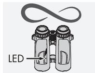
Ponovna kalibracija se preporučuje prilikom prelaska na novo lovište ili u slučaju velikih oscilacija temperature. Objekat od metala kao što su automobili ili dalekovodi mogu da utiču na pravac kompasa i kalibraciju.
