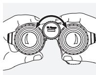
Okretanje kotačića za fokusiranje omogućuje vam da se fokusirate na bilo koji predmet od najmanje udaljenosti fokusiranja (pogledajte tehničke specifikacije) do beskonačnosti.
