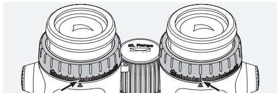
b. Nakon toga gurnite unutra prsten za izjednačavanje dioptrije. Ako je vid u jednom ili oba oka oštećen, podesite dvogled na način koji je opisan u odeljku 3.4. Displej mora da bude oštro fokusiran kako bi se ostvarile najbolje moguće performanse za utvrđivanje udaljenosti.
