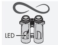
При перемещении в другой район охоты или при значительных колебаниях температуры рекомендуется повторная калибровка. Металлические объекты, такие как автомобиль или опора электропередач, могут оказывать влияние на показание компаса и процесс его калибровки. Если вы выполняете измерение рядом с оружием, рекомендуется держать устройство на расстоянии как минимум 40 см от ствола.
