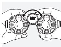
Otočením zaostřovacího kolečka můžete zaostřit na libovolný objekt od nejkratší zaostřovací vzdálenosti (viz list s technickými údaji) až do nekonečna.
