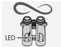
Při přesunu na jinou honitbu nebo v případě, že dojde k významným teplotním výkyvům, doporučujeme provést recalibraci.
