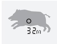
В режиме сканирования происходит непрерывное измерение расстояния до движущихся целей. Режим сканирования включается автоматически, если нажать кнопку измерений и удерживать ее дольше 3 секунд.
