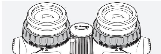
b. Apoi împingeți inelul de ajustare a dioptriei înapoi în poziția inițială. Dacă vederea la unul sau ambii ochi este afectată, reglați binoculul conform instrucțiunilor de la punctul 3.4. Pentru a obține cea mai bună performanță în stabilirea distanței, imaginea afișată pe ecran trebuie să fie foarte bine focalizată.
