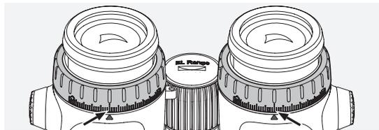
**б.** Затем задвиньте кольцо диоптрической настройки обратно. Если острота зрения одного или обоих глаз ослаблена, настройте бинокль как описано в разделе 3.4. Дисплей должен быть четко сфокусирован, чтобы обеспечить наилучшее определение расстояния.
