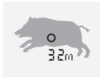
A mozgó célpontok távolsága folyamatosan mérhető pásztázó módban. A műszer automatikusan pásztázó módba vált, ha 3 másodpercnél tovább lenyomva tartja a mérőgombot.
