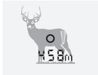
Krátkym stlačením tlačidla merania zobrazíte cieľovú značku. Po uvoľnení tlačidla sa na displeji zobrazí meranie vzdialenosti.
