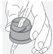
**Čistenie ochranného krytu.** Použite súpravu čistiaceho prostriedku a kefy (dodáva sa so zariadením). Zatvorte kryt okulára aj objektívu. Navlhčite kefku a kruhovými pohybmi naneste čistiaci prostriedok. Jemne kryt vyčistíte. Opláchnite ďalekohľad čistou vodou a opatrne ho nechajte vyschnúť. Ak dôjde k namočeniu optiky, jemnými dotykmi čistou handričkou ju osušte tak, aby ste predišli jej poškriabaniu. Kefku dôkladne opláchnite a nechajte súpravu čistiaceho prostriedku a kefy vyschnúť.
