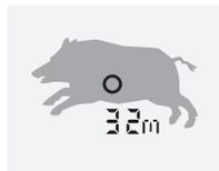
Pokretne se mete neprekidno mjere u načinu skeniranja. Instrument se automatski prebacuje na način skeniranja ako pritisnete i držite gumb za mjerenje duže od 3 sekunde.
