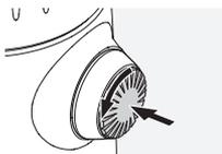
Pritisnite okruglu ručicu i okrenite je u smjeru suprotnom od kazaljke na satu (90°).
