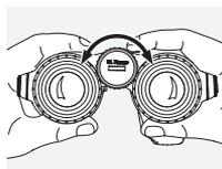
Rotirea roțiței de focalizare vă permite să focalizați pe orice obiect de la cea mai mică distanță de focalizare posibilă (a se vedea fișa de date tehnice) la infinit.
