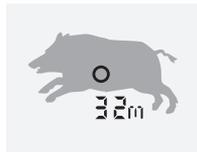
W trybie skanowania odległość od ruchomych celów jest mierzona w sposób ciągły. Urządzenie automatycznie przełącza się w tryb skanowania po naciśnięciu i przytrzymaniu przycisku pomiarowego przez ponad 3 sekundy.
