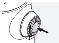
С усилием нажать на кнопку и немного повернуть ее по часовой стрелке.
