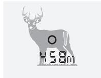
Kratko pritisnite dugme za merenje da biste prikazali nišan. Nakon otpuštanja dugmeta, izmerena udaljenost će biti prikazana na displeju.
