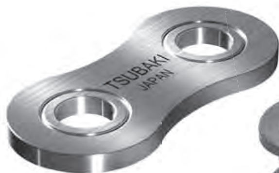
Patentoidulla Ring Coining -menetelmällä vahvistettu liitoslenkin irtosivulevy.
