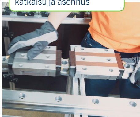
Lineaarijohteiden katkaisu ja asennus
