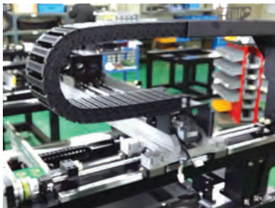
Sabin-ketju, puhdastila, testilaitte LCD-tehdas (nsb)
