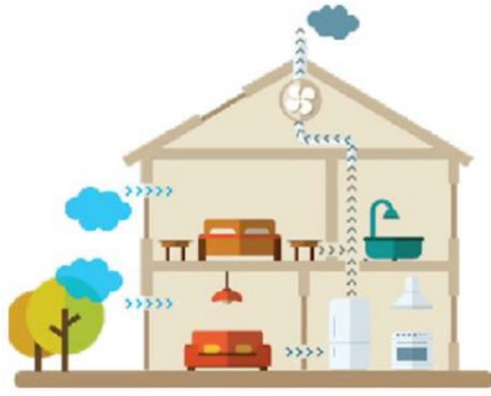
C – Mechanische ventilatie
