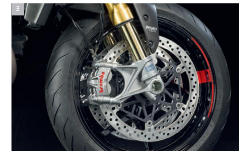
3 Freins avant avec disques Ø 330 mm et étriers Brembo monobloc M50 à fixation radiale
