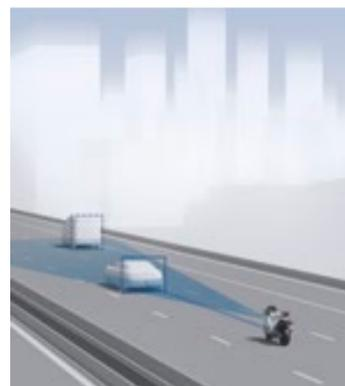
L'**Adaptive Cruise Control** regola la velocità del veicolo in base al flusso del traffico e mantiene la distanza di sicurezza, per ridurre con efficacia il rischio di tamponamenti.
