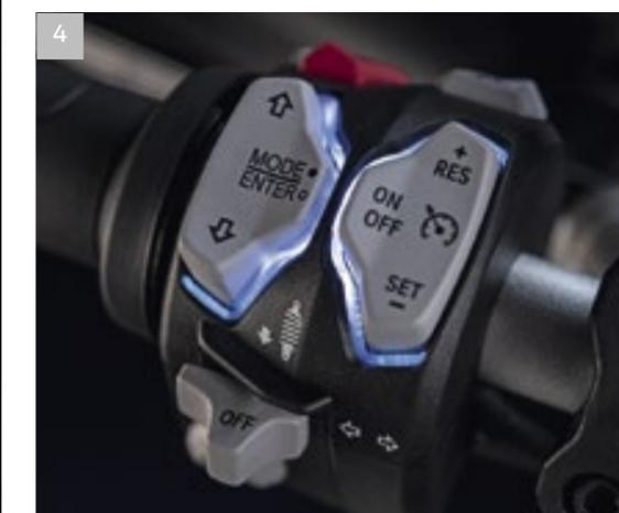
4 Commandes rétro-éclairées au guidon
