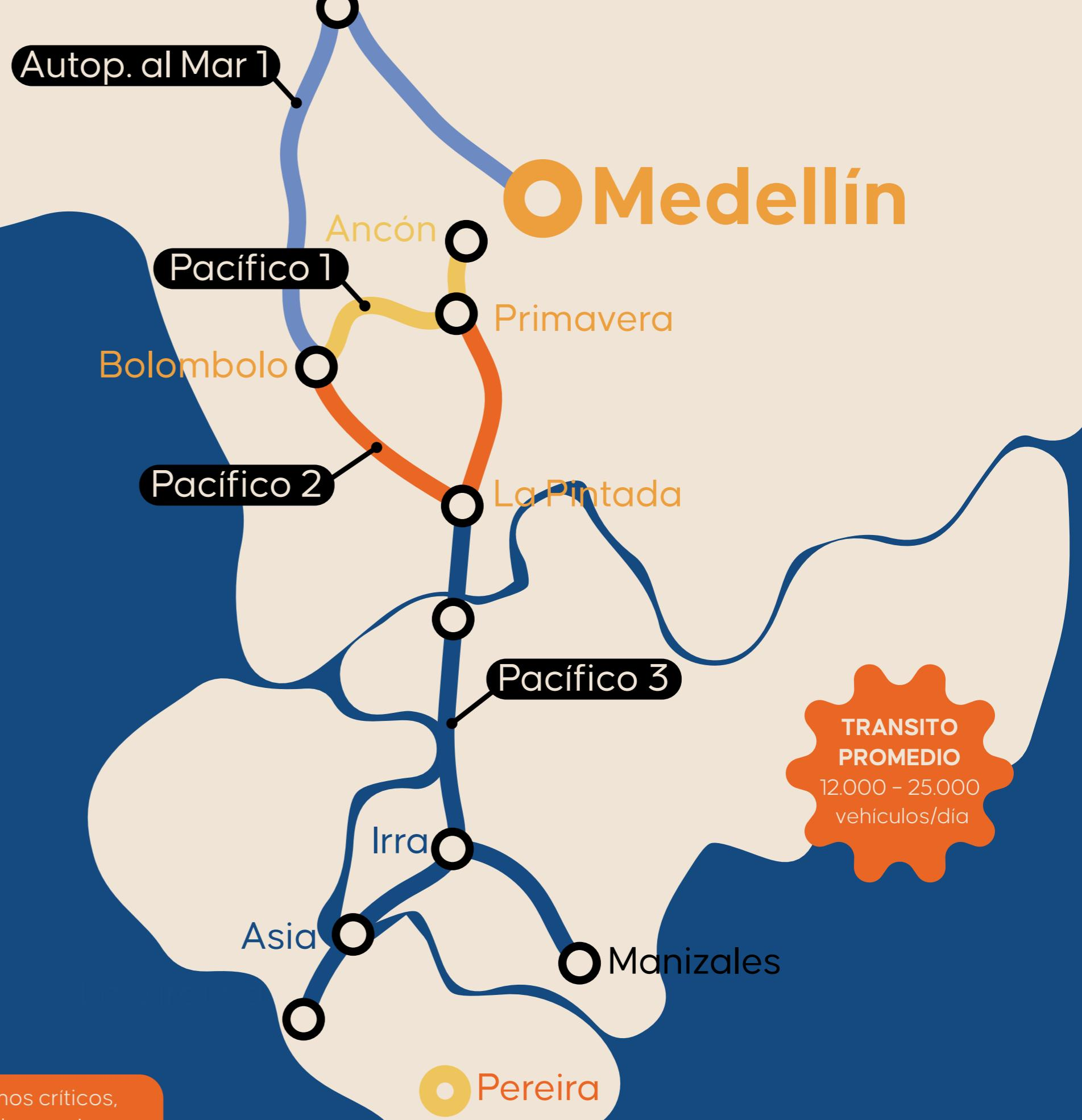
Vía 4G, tipo carretera primaria, con calzada sencilla mejorada y doble calzada en tramos críticos, túneles, viaductos y pendientes corregidas, diseñada para carga pesada y transporte de pasajeros.
