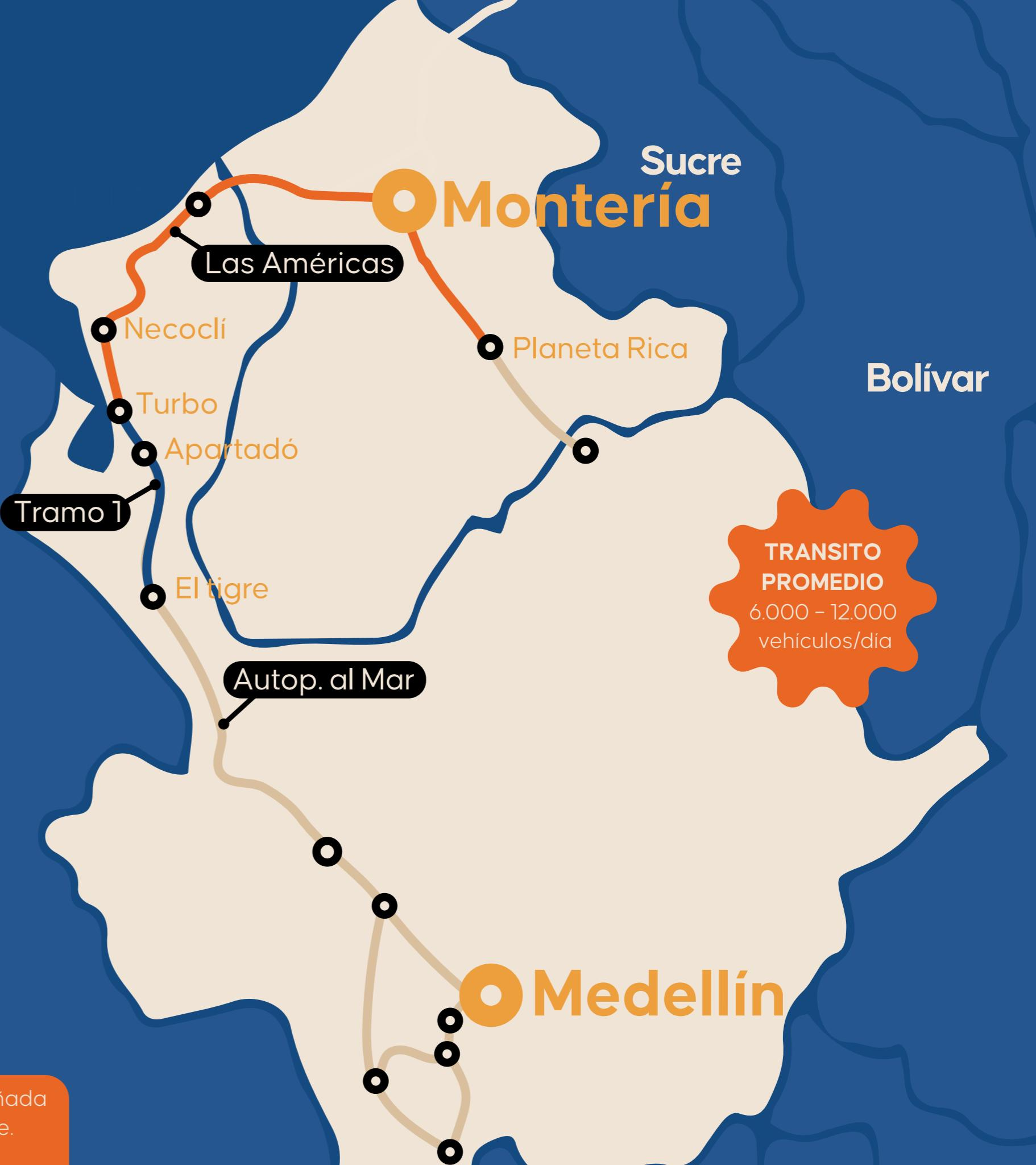
Vía primaria de integración regional, en calzada sencilla con intersecciones a nivel, diseñada para tránsito mixto de carga y pasajeros, conectando Urabá con Córdoba y el Caribe.
