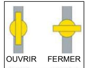
En cas de surchauffe ou si l'admission de gaz ne peut être coupée, ne pas couper ni débrancher l'alimentation électrique de la pompe. Fermer plutôt le robinet d'admission de gaz à l'extérieur de l'appareil.
