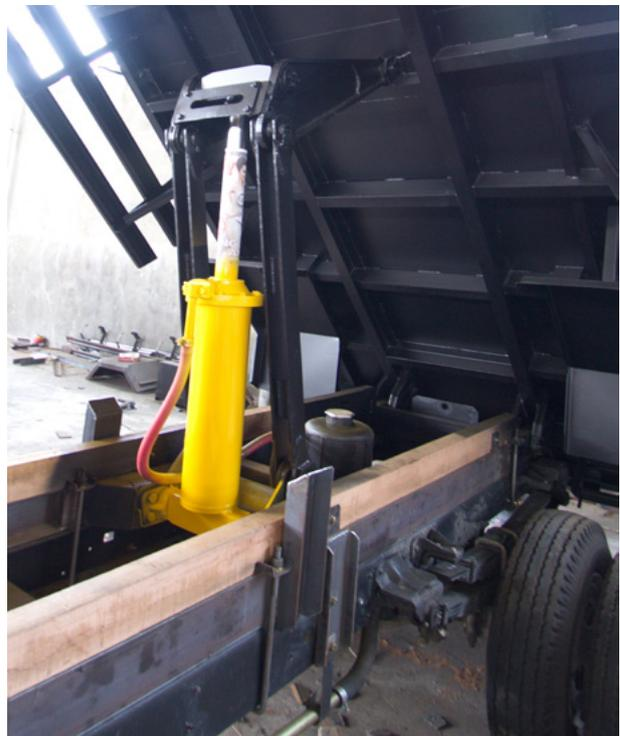
Perangkat hidrolik dari *dump truck* ukuran paling kecil
