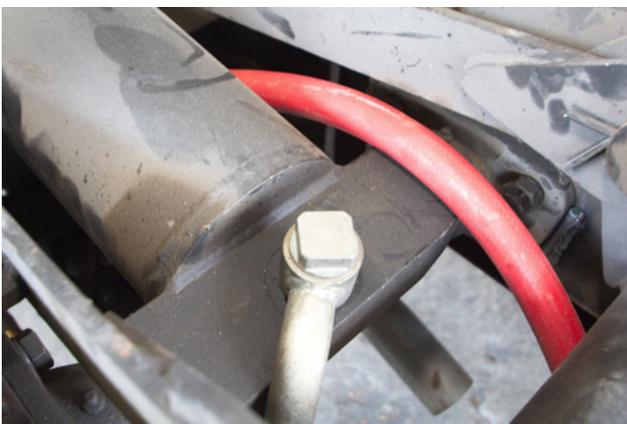
Bagian O-Ring perlu pengencangan agar alur oli ke hidrolis lancar
