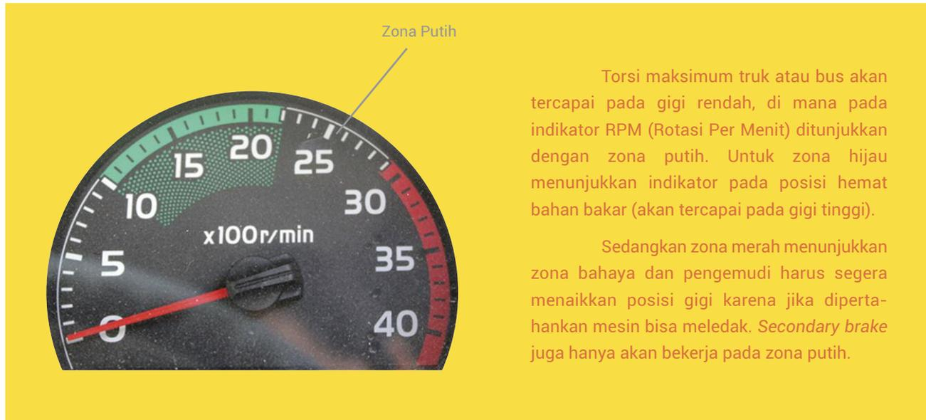
Torsi maksimum truk atau bus akan tercapai pada gigi rendah, di mana pada indikator RPM (Rotasi Per Menit) ditunjukkan dengan zona putih. Untuk zona hijau menunjukkan indikator pada posisi hemat bahan bakar (akan tercapai pada gigi tinggi).
