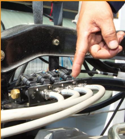
Injector sebagai penyemprot gas ke dalam mesin
