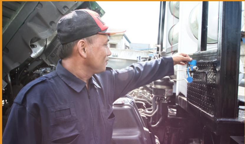
Teknisi memperlihatkan Filling valve, katup untuk pengisian gas (*refilling*) dari SPBG.
