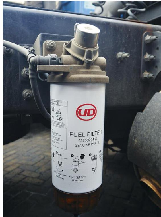
Primary filter dengan tingkat kerapatan elemen penyaring antara tujuh sampai delapan mikron
