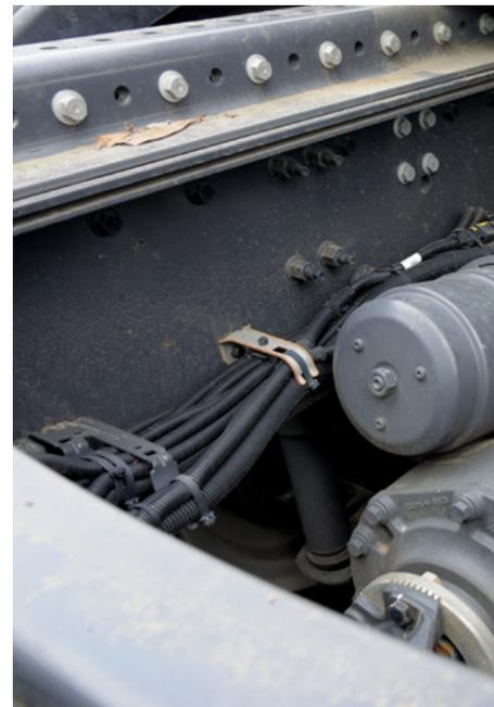
Letak sistem utama air brake pada truk
