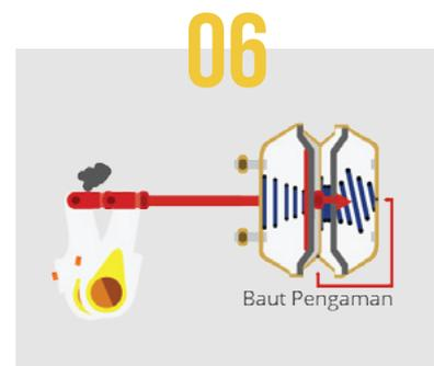
Gambar 6 adalah cara mengatasi keadaan darurat di jalan bila terjadi kegagalan sistem pengereman. Setiap spring brake chamber terdapat baut pengaman, berfungsi untuk membebaskan spring brake chamber dengan cara dipasangkan di belakang spring brake chamber dan kencangkan. Roda dapat bebas kembali.
