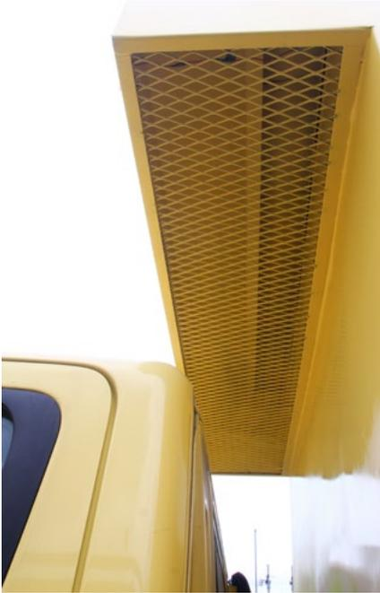
Fan terinstal di bagian atap, mengambil udara dari luar lewat ujung depan boks
