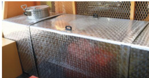
Water tank untuk counter weight
