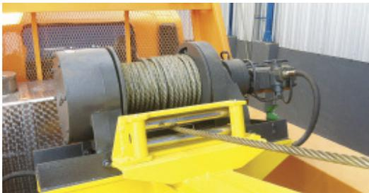
Winch dengan kekuatan 22 ton bisa di-ugrade dengan perangkat semacam kerekan untuk mengangkat beban 2 kali lipat
