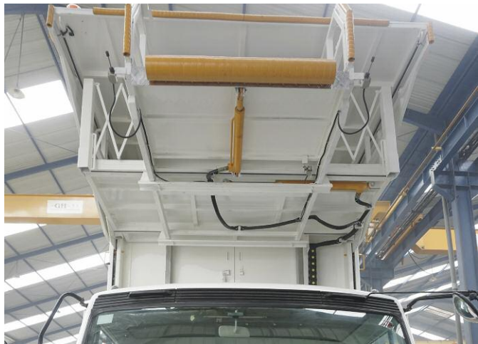
Jembatan dan lidah box sebagai penghubung box dan badan pesawat
