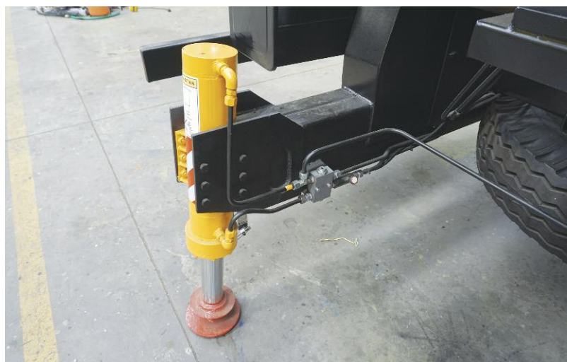
Landing jack untuk kestabilan bongkar muat catering
