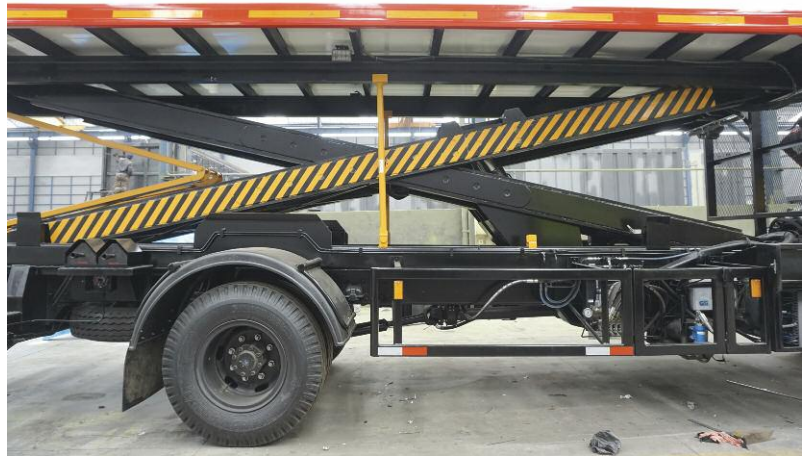
Batang stabilizer untuk pengaman ketika maintenance
