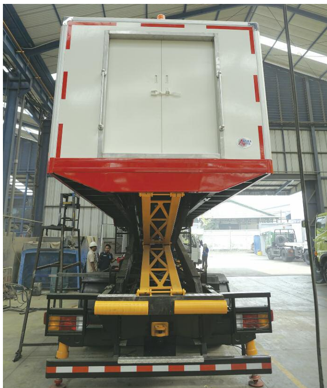
Dinding samping, atas dan kusen belakang menggunakan material polystyrene
