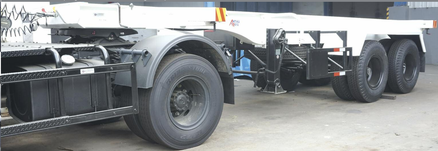
Stabilitas trailer dipengaruhi beban muatan bagian depan
