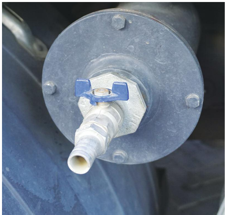
Kran air untuk membersihkan bagian dalam hopper
