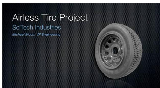
Sebagai ganti jari-jari yang menjulur dari pusat roda, mereka menggunakan penunjang berbentuk *spring-like*, terbuat dari *thermoplastic glass fiber* material komposit. SciTech menutup dinding samping agar tidak terlihat jari-jarinya, sehingga tidak ada masalah dengan getaran serta suara berisik, dan juga tidak terdapat masalah dengan serpihan atau batu-batu kecil yang terperangkap pada jari-jari ban.
