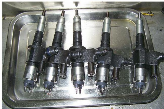
Perbaikan injektor pada mesin common rail bisa dilakukan pada bengkel spesialis diesel
