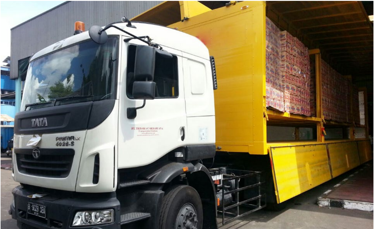
Adanya double deck dapat memaksimalkan muatan melebihi kapasitas dari sebelumnya yang hanya menggunakan satu lantai.
