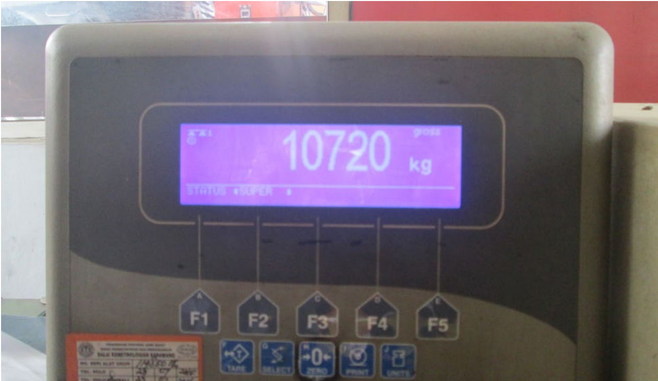
Penggunaan alat ukur jembatan timbang secara digital guna lebih mengakuratkan hasil timbangan yang di peroleh .
