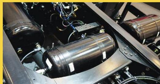
Air tank yang terhubung langsung pada sistem *axle lifting* letaknya menyatu di *crossmember* dengan kapasitas tampung hingga 15 liter
