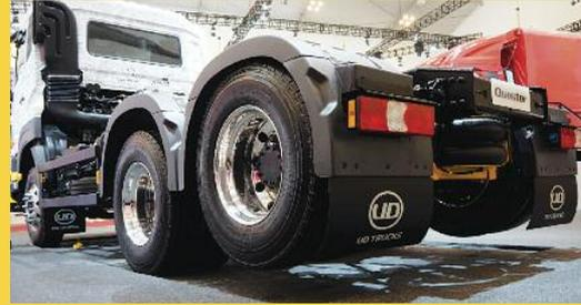
Posisi sumbu roda paling belakang terangkat artinya sistem *axle lifting* dalam posisi aktif dan butuh kompresi 9 bar
