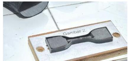
Sampel ban/flap untuk Tensometer
