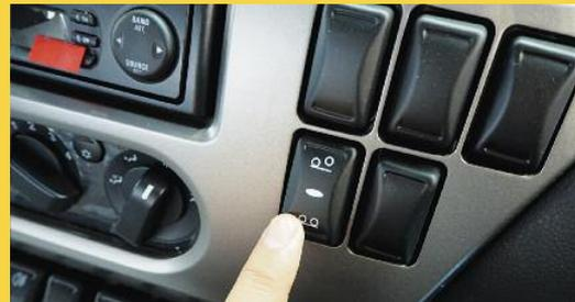
Tombol switch ON/OFF pada sistem *axle lifting* pada UD Trucks Quester terletak di dasbor dekat panel radio-tape
