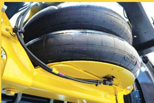
Periksa secara rutin kondisi kabel slang udara yang terhubung langsung ke bagian balon, jangan sampai ada kebocoran angin di sektor ini
