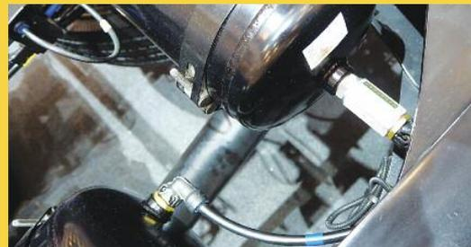
Lakukan pemeriksaan rutin pada seluruh selang di semua tangki udara, karena seluruh tangki saling terkait untuk pasokan udara dari kompresor udara mesin
