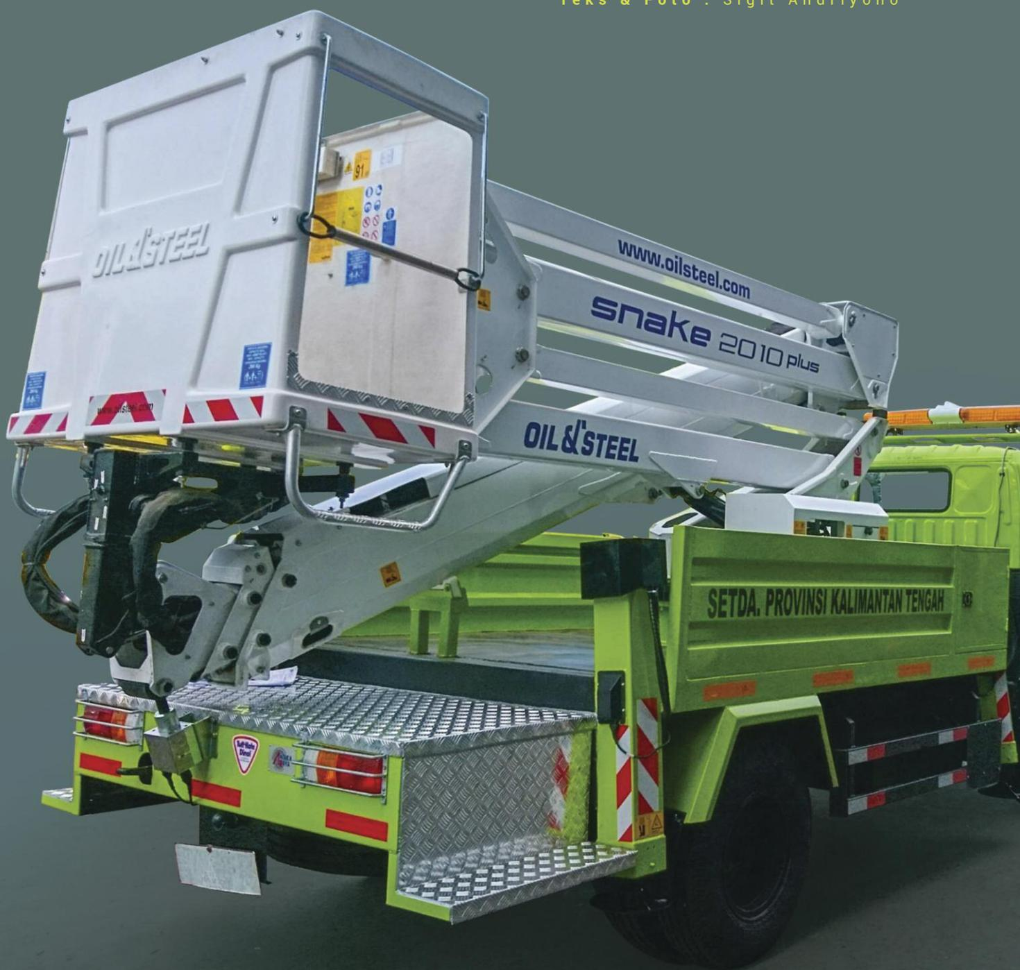
*Aerial Platform Truck* (APT) adalah kendaraan pendukung pekerjaan yang berhubungan dengan area kerja di ketinggian, umumnya dimanfaatkan di pergudangan, perawatan jalur hijau, dan perbaikan lampu jalan. APT ini memanfaatkan PTO dengan mekanisme *gear pump*.
