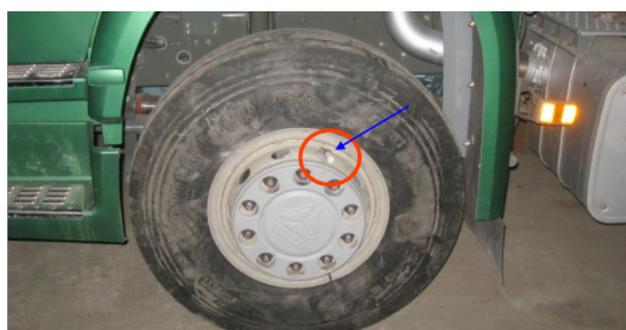
Alat TPMS yang terhubung ke pentil (valve)
