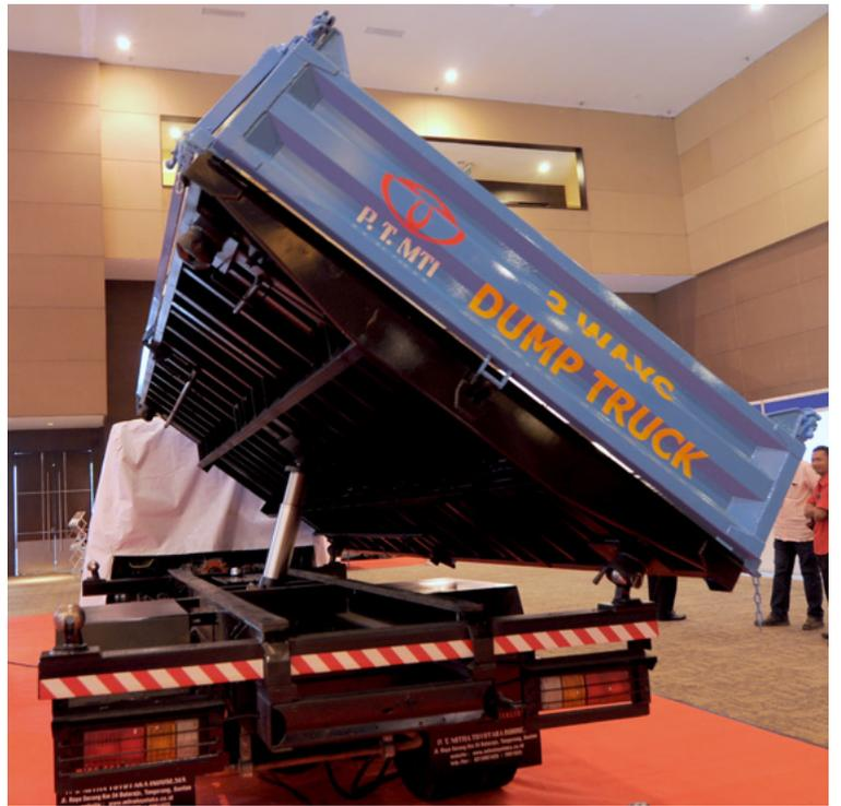
Dengan dilengkapi hidrolik di sisi bawah loss bak, maka sopir dapat bongkar muat barang secara fleksibel menyesuaikan tempat yang diinginkan.
