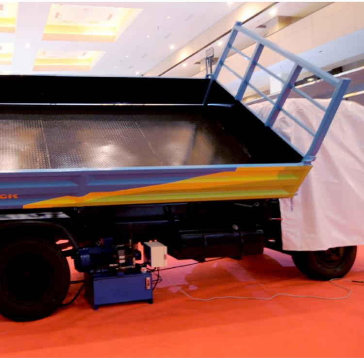
Three Ways Dump Truck memiliki panjang 4 meter dan lebar 2,4 meter yang dikombinasikan dengan sasis light truck 6 ban mampu mengangkat muatan 3 hingga 4 meter kubik.
