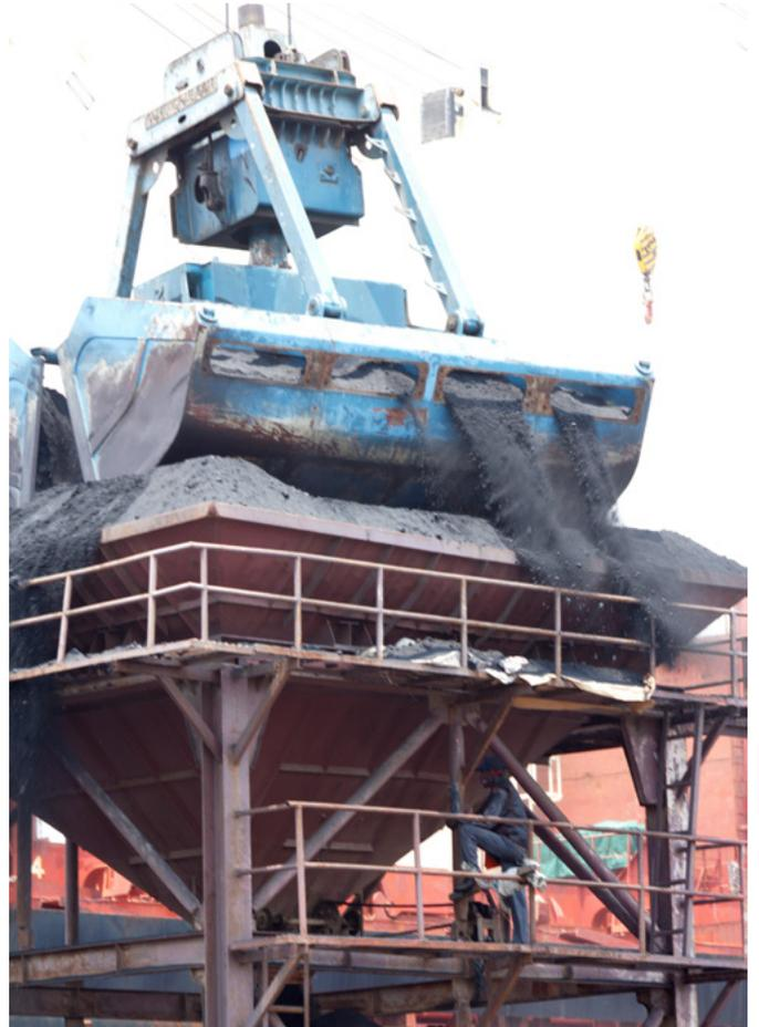
Proses bongkar muat curah kering dari kapal menggunakan harbour mobile crane dengan ship grab yang memanfaatkan hopper
