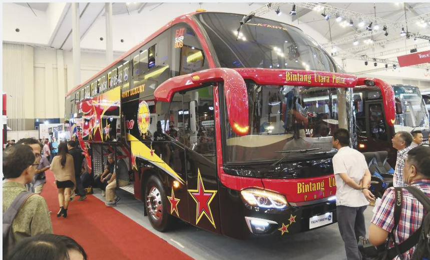
Bus Avante SHD dari Karoseri Tentrem ini pesanan PO Bintang Utara Prima dan diperkenalkan di GIIAS 2018. Bus maxi ini memiliki panjang 13,5 meter dan dibangun di atas sasis Mercedes-Benz OC500RF 2542.
