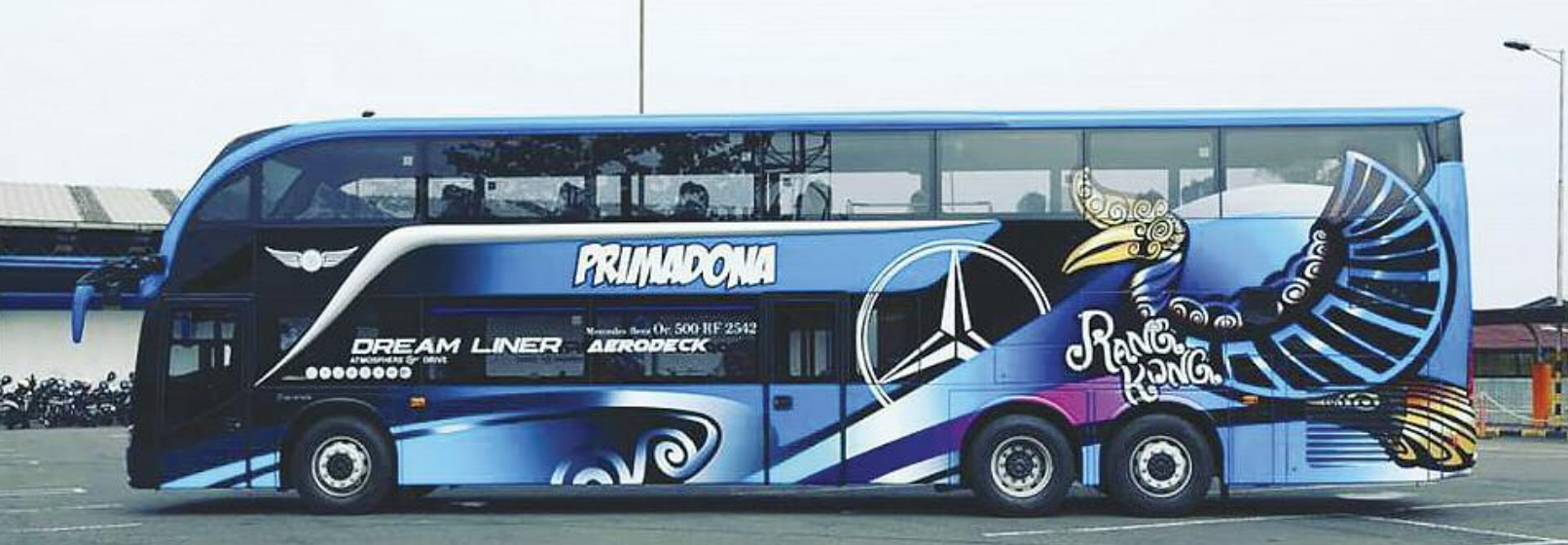
Bus double decker Highlander produksi Karoseri New Armada Magelang ini merupakan pesanan PO Primadona, Makassar. Bus maxi 13,5 meter ini dibangun di atas sasis Mercedes-Benz OC500RF 2542.
