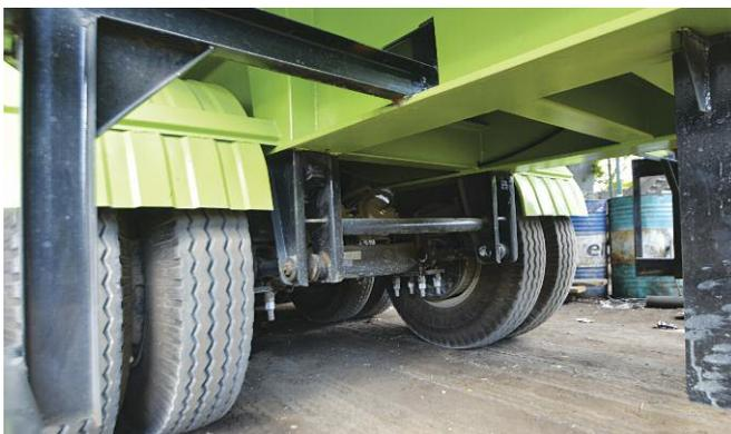
"Distribusi beban yang merata harus sedemikian rupa sehingga tidak ada bagian komponen dari trailer yang membawa beban di luar kemampuannya. Operator harus mempertimbangkan kekuatan tonase ban, roda dan as roda. Untuk jenis trailer tandem dan poros *triple*, distribusi beban *front-to-rear* tidak menghasilkan kelebihan beban pada as roda mana pun," jelas Edrik.
