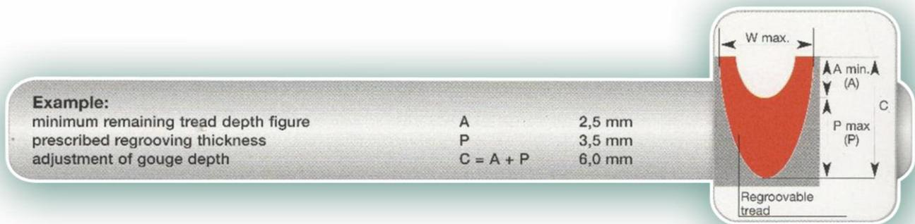
didesain oleh pabrik untuk dapat di-regroove, lapisan karet pada cerukan alurnya dibuat lebih tebal daripada ban yang tidak bisa di-regroove, supaya memungkinkan dilakukan proses regrooving. Ban yang dapat di-regroove memiliki tanda "REGROOVABLE" yang tercetak di dinding samping ban.
