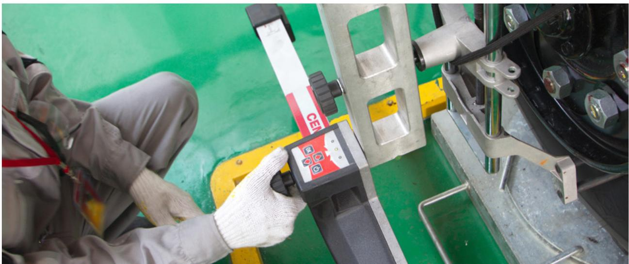
Operator mengatur kestabilan alat untuk mencari posisi pada roda
