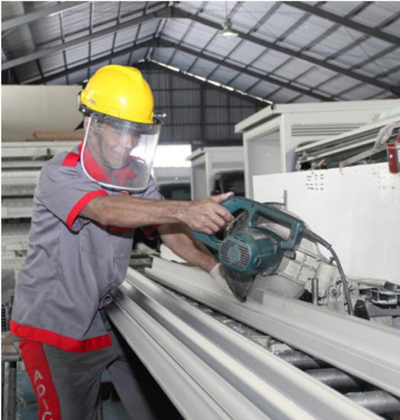
Mekanik memotong material logam untuk rangka wingbox
