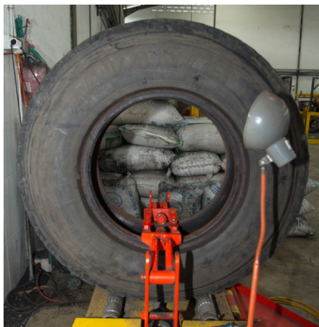
Proses pamarutan bertujuan untuk menghilangkan tapak yang sudah aus dan membuat permukaan ban agar merata.
