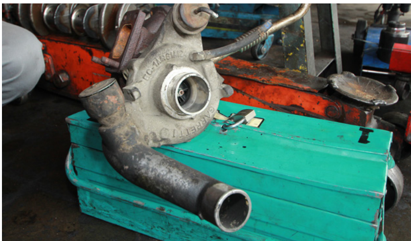
Saluran intercooler pada turbocharger
