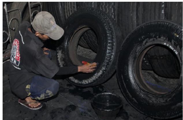
Setelah semua proses vulkanisir ban selesai, dilakukan proses penyemiran agar ban terlihat baru.
