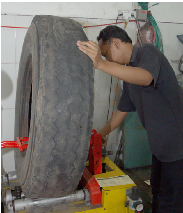
Pemeriksaan kondisi fisik ban dari lubang, sobek, retak, dan sebagainya.
