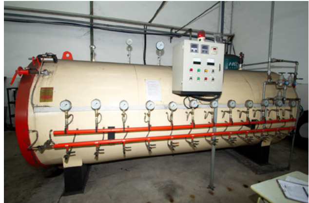
Mesin chamber berfungsi menyatukan semua elemen tadi (casing, gum, tread) menjadi satu.
