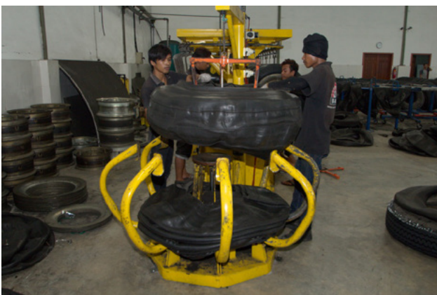
Proses pembungkusan ban yang hendak divulkanisir dengan bungkus khusus untuk memastikan agar casing ban yang telah diproses building dapat ditempel menjadi satu dengan baik.
