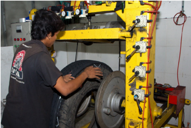
Proses penempelan cushion gum dan tread rubber dengan casing.
