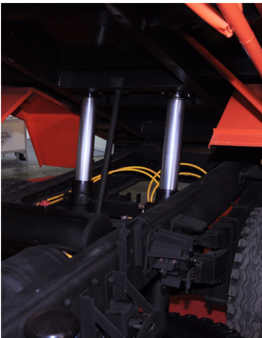
Wolf memiliki dua hidrolis dengan masing-masing kapasitas 5 ton.
