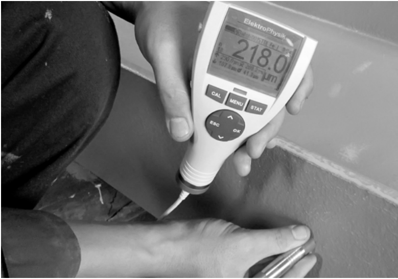
Proses pengecekan ketebalan profil baja telah menjadi standard quality control PT Nicovindo Mandiri
