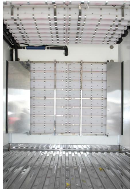
Setiap modul PCM yang rusak bisa langsung diganti tanpa mengganti keseluruhan rangkaian modul
