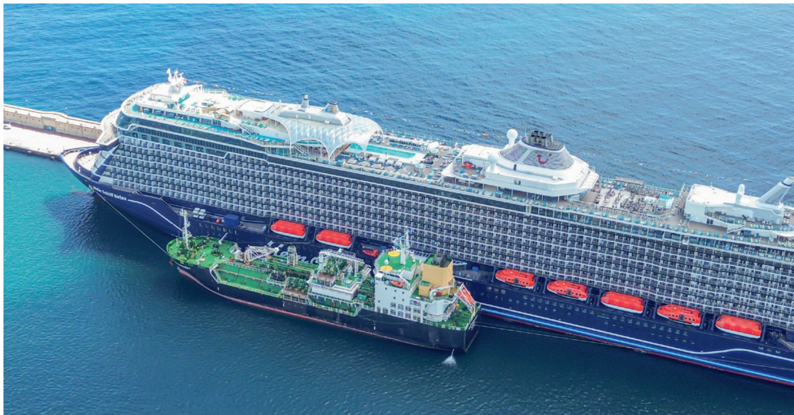
Erste Bio-LNG-Bunkerung der Mein Schiff Relax : Der Mein Schiff ® Neubau wird im Hafen von Barcelona mit dem biogenen Flüssiggas betankt.
