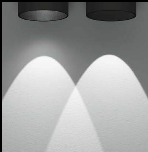
links: konventionelle schwarze Beschichtung rechts: ultraschwarze Nanobeschichtung
