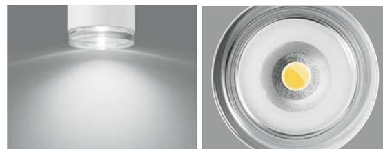
Las **coronas circulares con cristal transparente** son luminarias con cristales transparentes parcialmente mateados de gruesas paredes, cerrados hacia arriba y hacia abajo. La orientación de la luz en el espacio tiene lugar a través de reflectores incorporados con una distribución superextensiva hacia arriba y hacia abajo. Los cristales transparentes de fabricación artesanal definen la apariencia solemne de las luminarias y convencen por su juego de luces brillante con múltiples matices.
