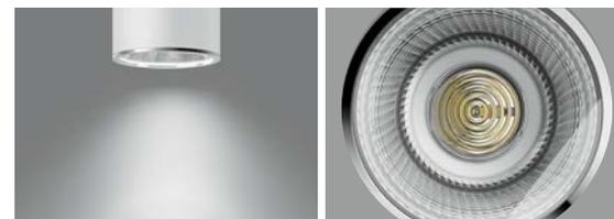
**Les couronnes lumineuses avec BEGA Hybrid Optics®** sont des spots à répartition lumineuse extensive. Ce système optique utilise des réflecteurs et des lentilles. Il en résulte des systèmes optiques fermés en haut et en bas, hautement efficaces, à faibles déperditions et à protection optimale contre l'éblouissement, dans des dimensions très compactes. Les couronnes lumineuses dotées de cette technique d'éclairage séduisent par leur rendement élevé et leur grande qualité d'éclairage.
