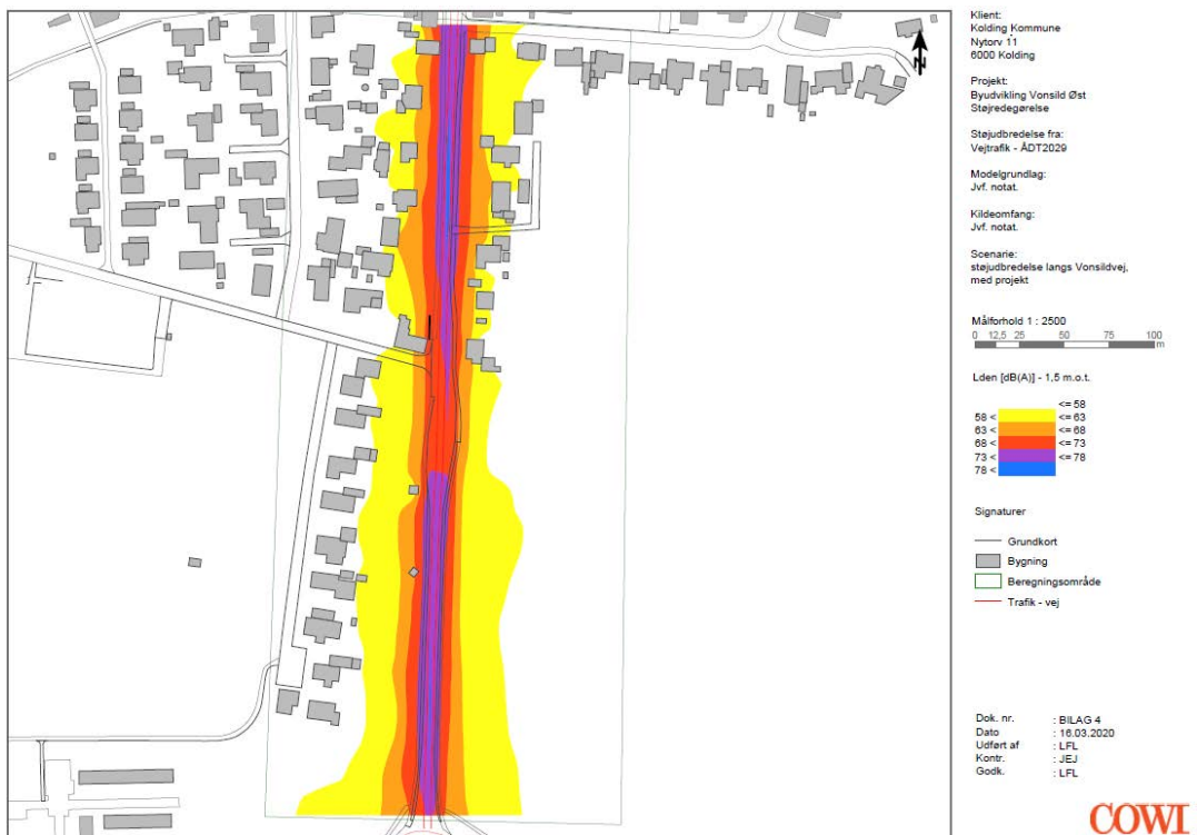
Figur 3. De beregnede støjkonturer for en situation i år 2029 med fuld udbygning af det nye planområde (bilag 4 i rapport fra COWI)
