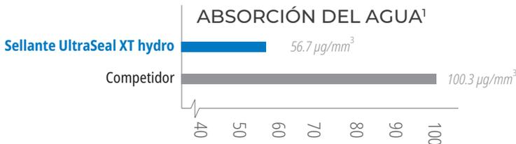
Una absorción de agua equilibrada permite la tolerancia en los entornos húmedos sin degradación.
