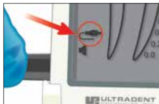
1. Kytke mittausjohto laitteeseen. Näyttöön tulee näkyviin liittimen symboli.
